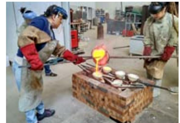
Proceso de vaciado del metal en el molde cerámico.
