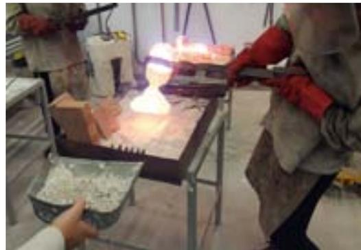
Volteo de la pieza con el metal ya fundido.
