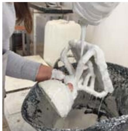
Baño de la pieza en la papilla (mezcla de sílice coloidal y moloquita).
