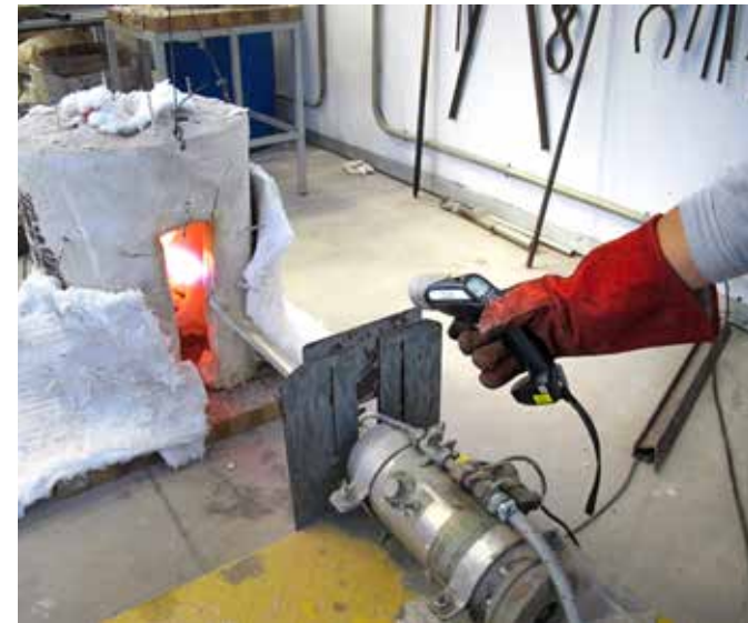
Fig.63. Mustreo de temperatura con medidor laser.
