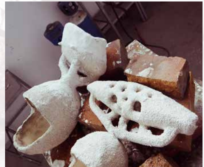
Fig.65. Unión de pieza a crisol con fibra y aplicación de pelo en los bordes por grietas o a modo de reguerdo FT5 y FT2.
