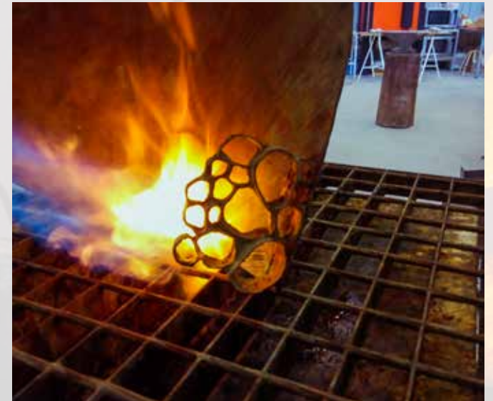
Fig.58. Proceso de aplicación de pátina FT15.
