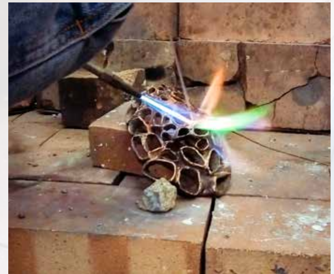
Fig.66. Relleno con soldadura de un rechupe FT4.
