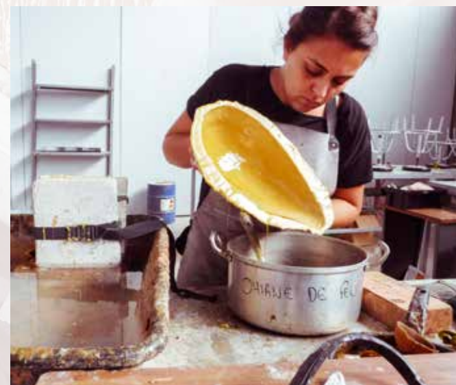
Fig.56. Llenado de molde por volteo.
