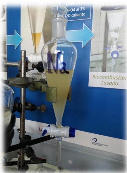
**Figura 2.18.** Fases obtenidas tras la reacción de transesterificación.
