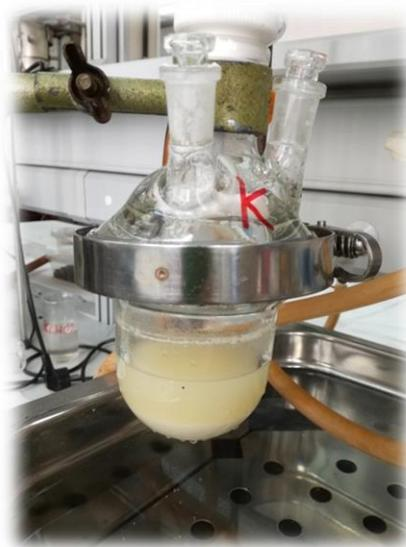
**Figura 2.16.** Reactor tras la transesterificación de aceite de girasol con el K/CaO como catalizador heterogéneo.
