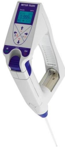
**Figura 2.20.** Densímetro Mettler Toledo modelo Densito 30PX.
