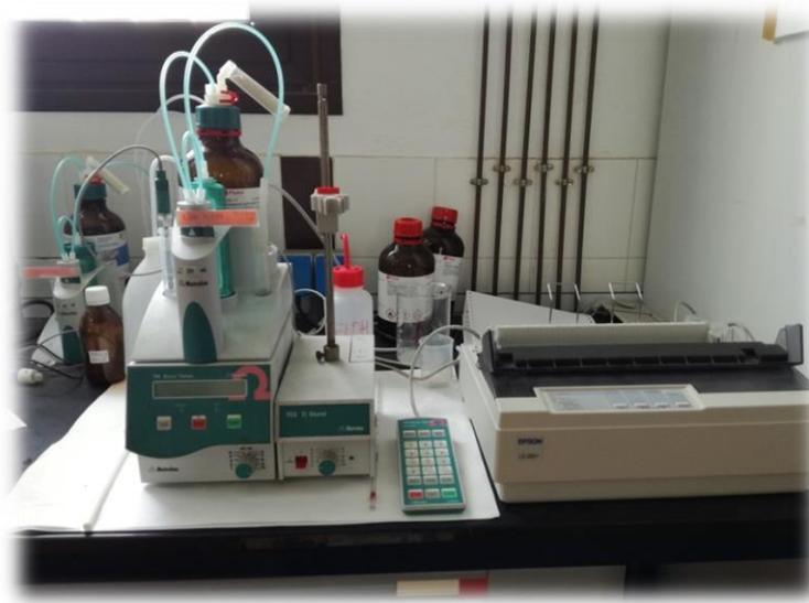
**Figura 2.21.** Valorador automático Metrohm modelo Titrino 794
