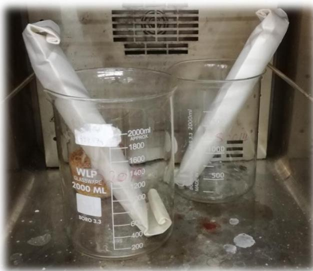
**Figura 2.7.** Cartuchos de semillas en la estufa después de la extracción.
