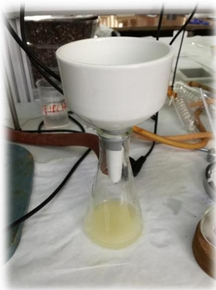
**Figura 2.17.** Filtración al vacío, para la separación del catalizado heterogéneo de los productos de reacción.
