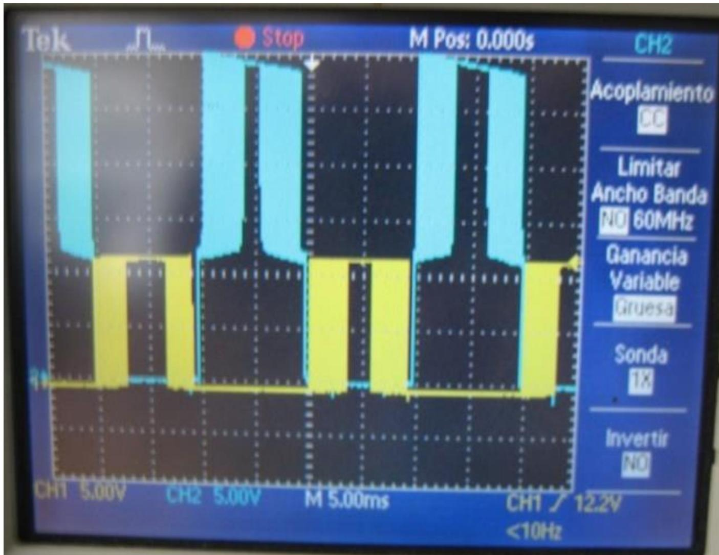
**Figura 40:** Fotografía de las salidas del driver con carga conectada.(Amarillo salida Bgate, azul salida Tgate)
