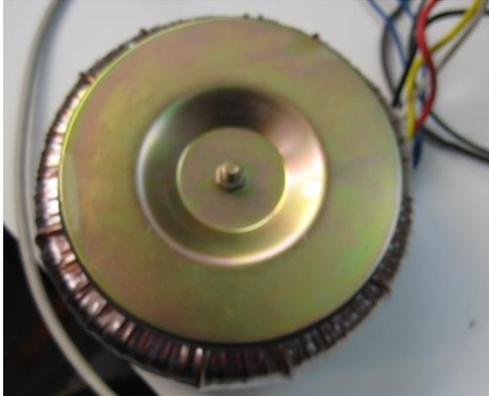
**Figura 58:** Fotografía de transformador utilizado en la carga, plano alzado.
