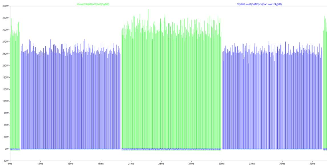
**Figura 45:** Potencia de los mosfet, Puente en H, carga resistiva.
