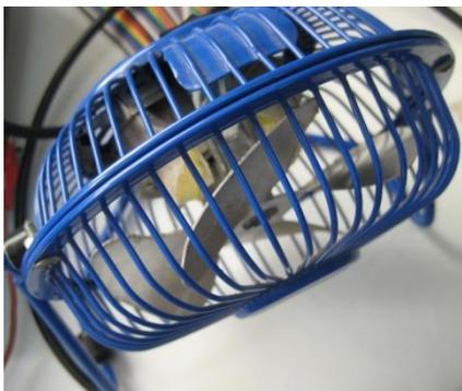
**Figura 60:** Fotografía del ventilador utilizado como carga inductiva.
