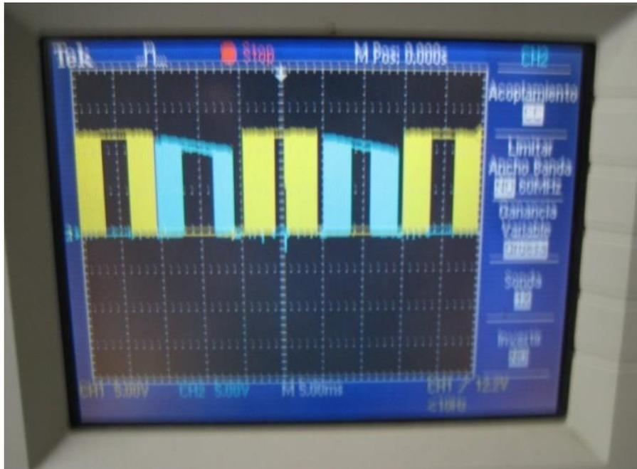
**Figura 39:** Fotografía de la salida del driver en el osciloscopio (Amarillo salida Bgate, azul salida Tgate)
