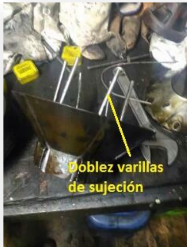
Ilustración 73. Disco superior con varillas. Trabajo de campo
