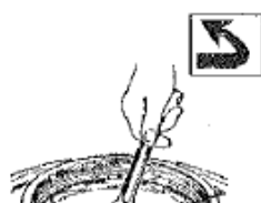
Ilustración 48. Apriete de tuerca. Fuente [7]
