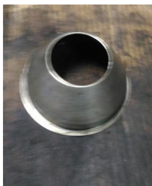
Ilustración 20. Disco de gravedad. Trabajo de campo
