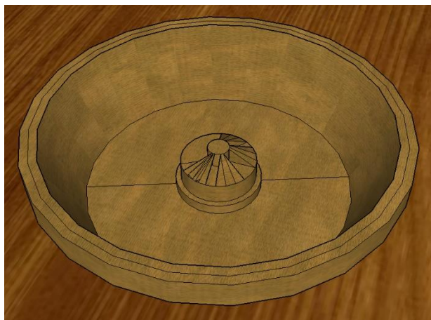
Ilustración 130. Anillo distribuidor superior. Elaboración propia
