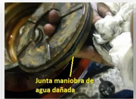
Ilustración 75. Junta de maniobra pisada. Trabajo de campo
