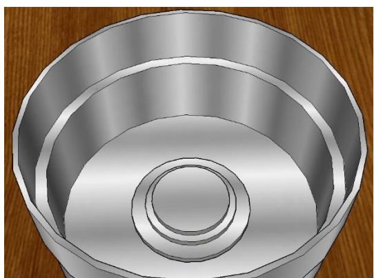
Ilustración 135. Cuerpo del rotor. Elaboración propia
