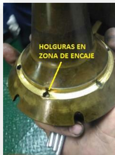
Ilustración 74. Distribuidor dañado. Trabajo de campo
