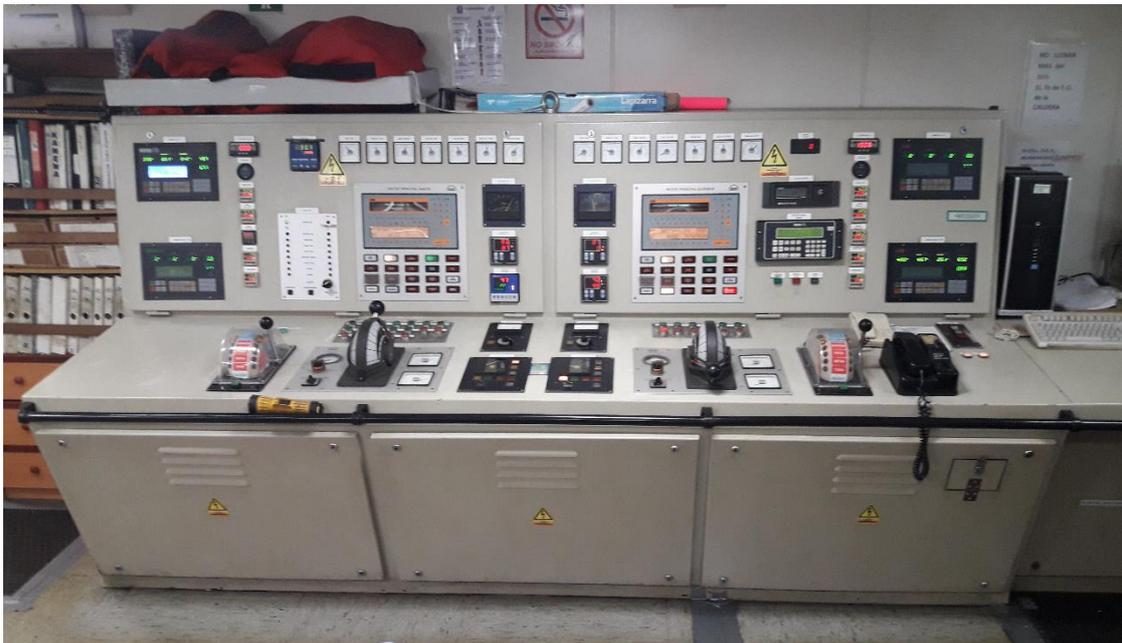
Ilustración 30. Consola de equipos de propulsión. Fuente: propia
