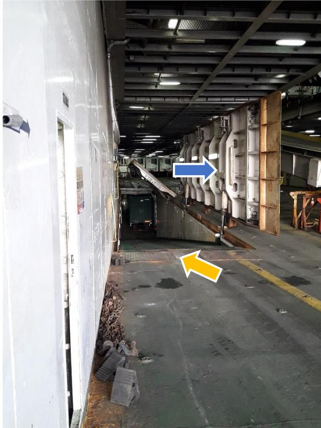
Ilustración 3. Rampa fija y pivotante del bodeguín. Fuente: [2].
