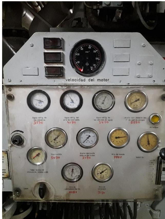
Ilustración 35. Control local de los parámetros de los motores principales. Fuente: propia.
