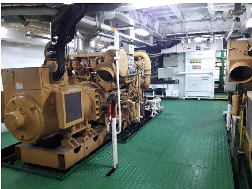
Ilustración 16. Motores auxiliares Caterpillar 3508 B. Fuente: [2].
