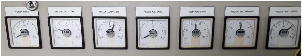
Ilustración 34. Control de los parámetros de los motores principales. Fuente: propia.
