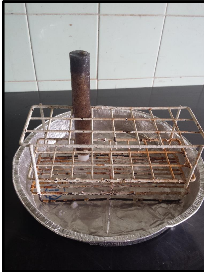
Figura 5.30: Tubo antes del desmolde. Fuente: Propia.
