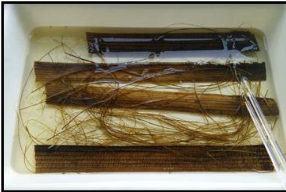
Figura 4.5: Fibras sumergidas en disolución 1N de NaOH (1). Fuente: Propia.
