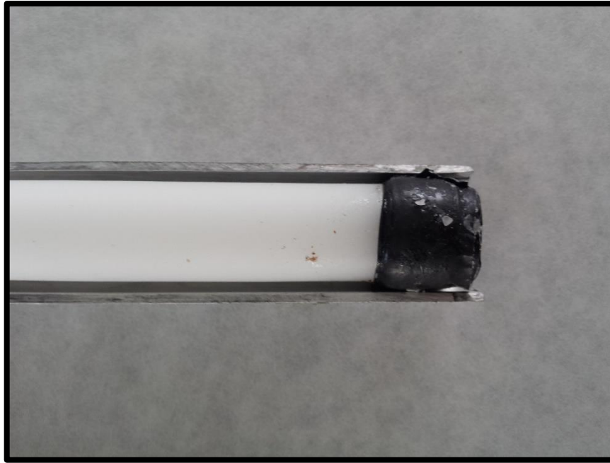
Figura 5.19: Vela dentro del molde. Fuente: Propia.
