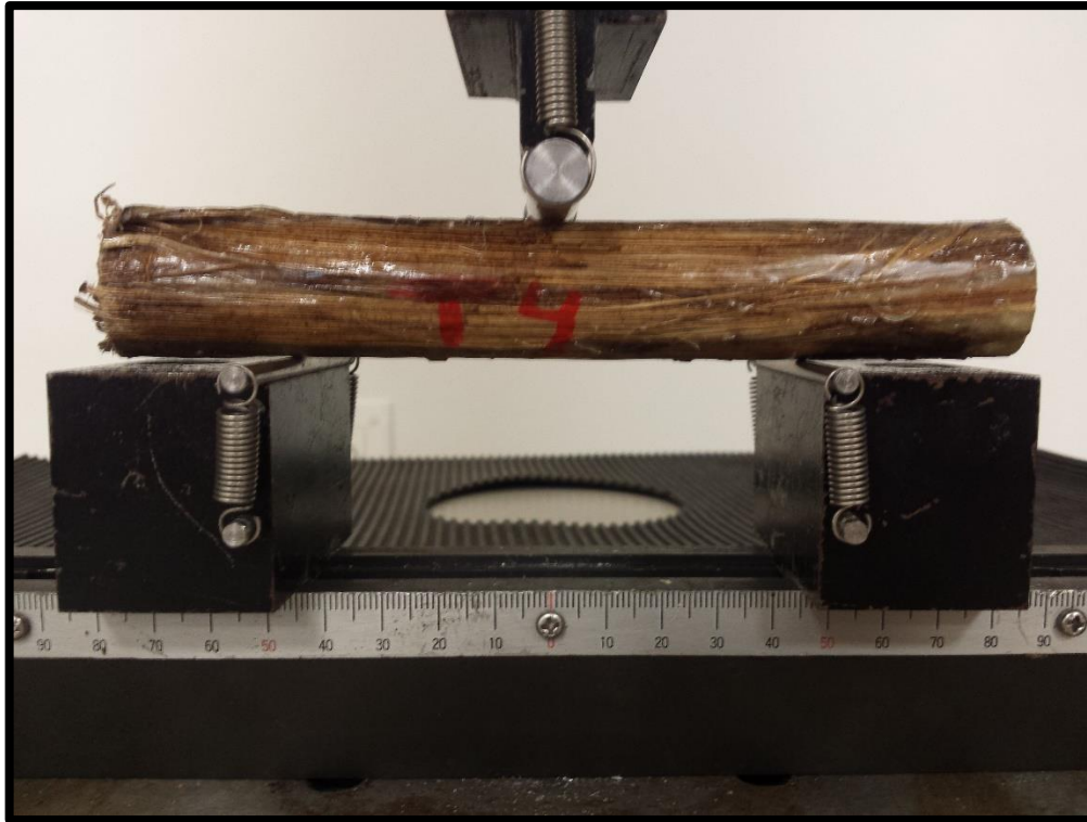
Figura 7.10: Ensayo de 3 puntos tubo de fibra de platanera. Fuente: Propia.
