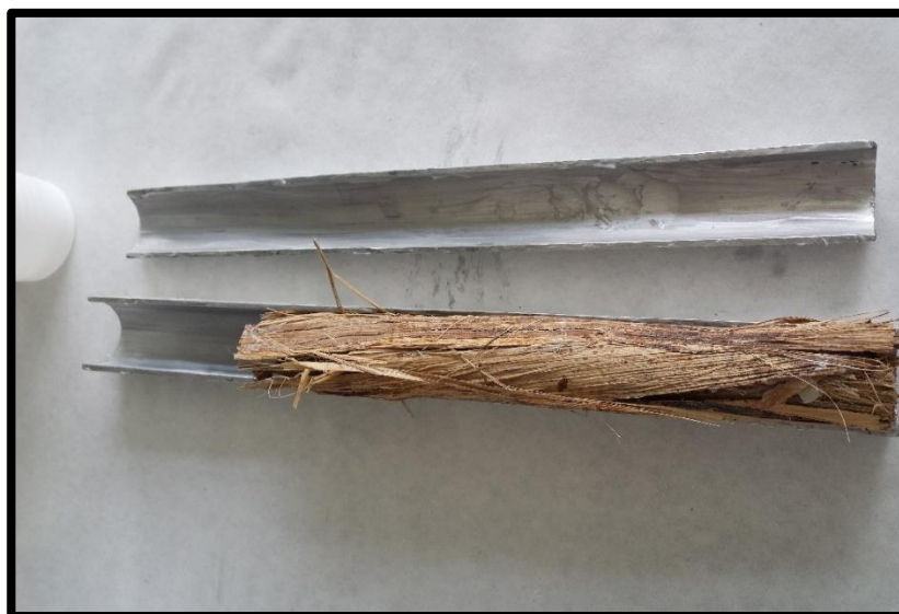
Figura 5.28: Fibras dentro del molde. Fuente: Propia.
