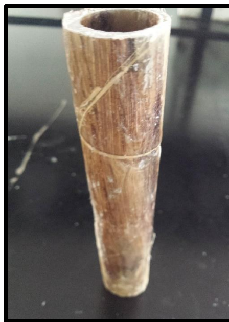
Figura 5.29: Probeta tubular con refuerzo de fibra de platanera tratada químicamente en disposición longitudinal. Fuente: Propia.
