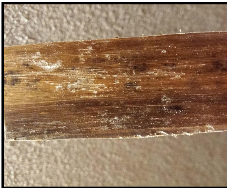
Figura 5.8: Detalle de las probetas fabricadas con fibras tratadas químicamente. Fuente: Propia.
