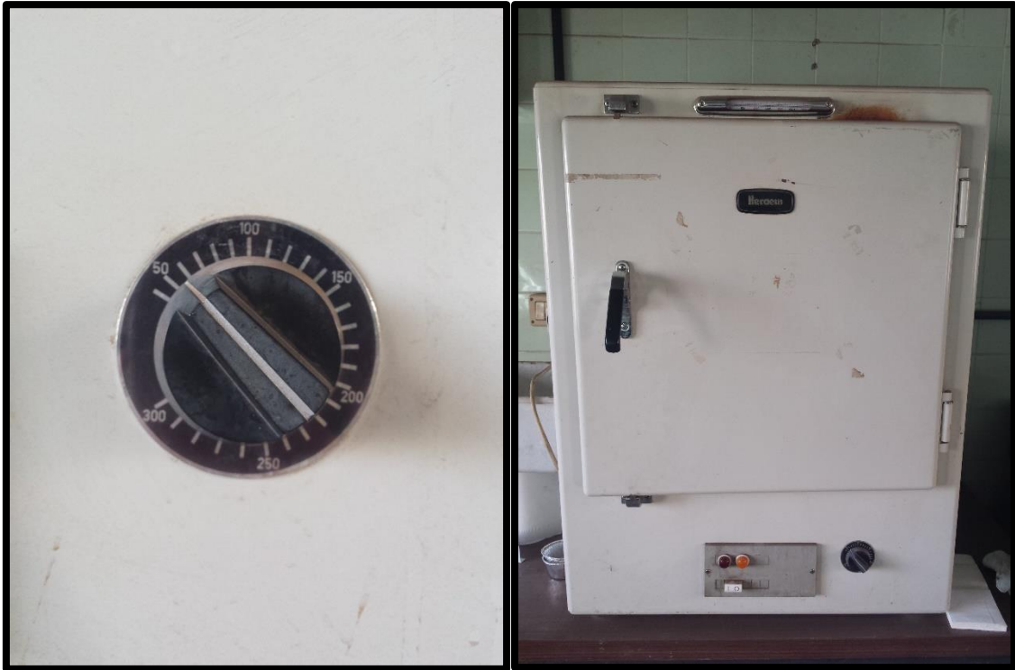
Figura 5.22: Horno para el desmolde. Fuente: Propia.
