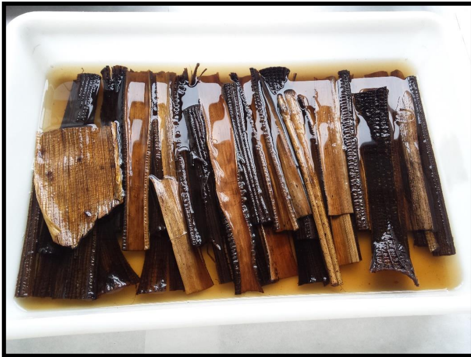
Figura 4.6: Fibras sumergidas en disolución 1N de NaOH (2). Fuente: Propia.
