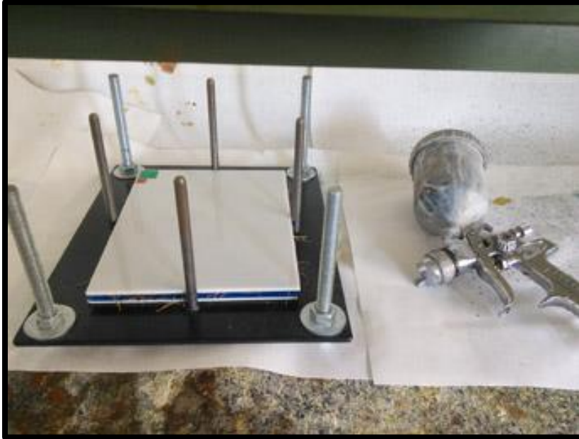
Figura 5.2: Sistema de aplicación de la resina bajo campana extractora, pistola y prensa usada. Fuente: Propia.
