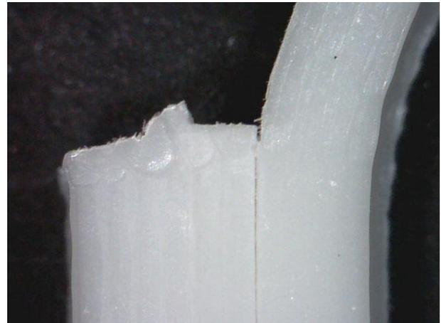
*Microfotografía tracción 10: Relleno concéntrico (P5)*
