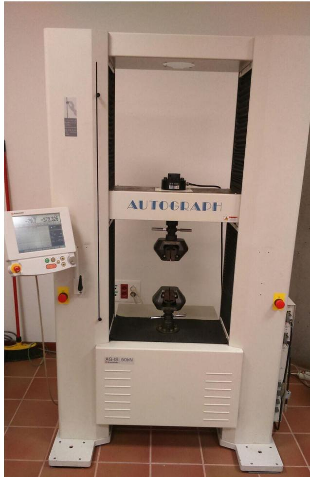
*Figura 1-Máquina de ensayos mecánicos empleada*
