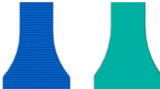
Figura 8-Aproximación de las capas a la curvatura. Efecto escalera [5]
