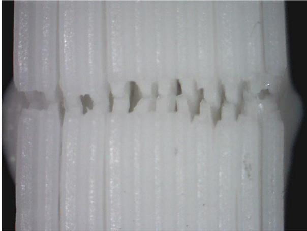
*Microfotografía flexión 7: Material nuevo y relleno concéntrico (P1)<sup>4</sup>*
