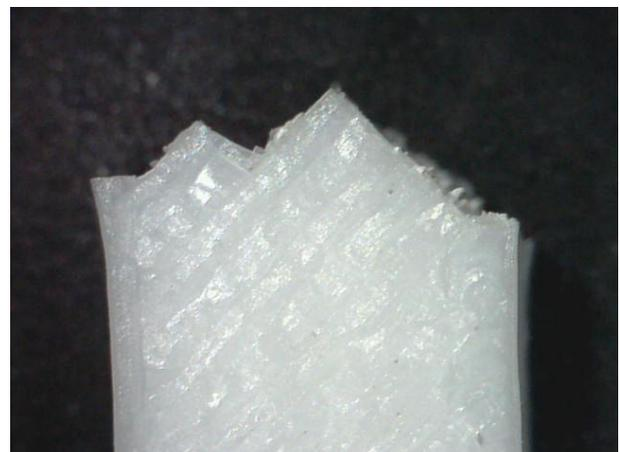
*Microfotografía tracción 6: Curado (55°C, 3 horas) (P3)*
