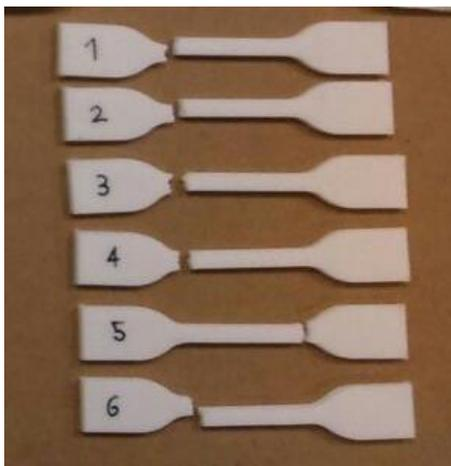
Figura 37-Probetas tracción: Curado (55°C, 3 horas)
