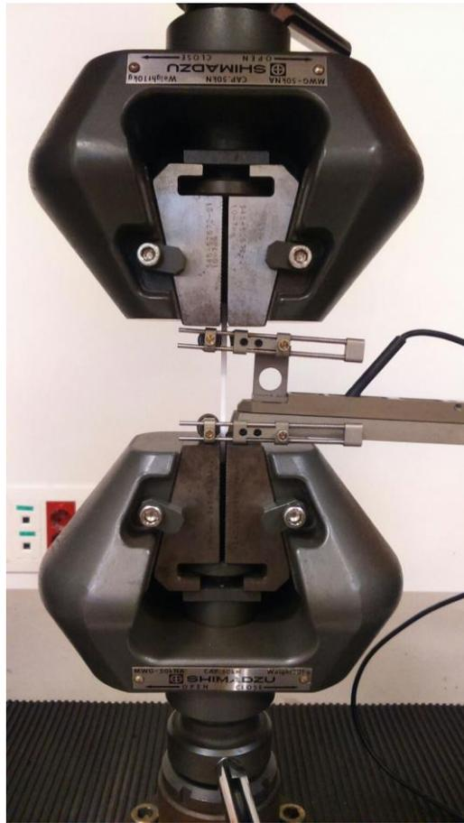
Figura 24-Montaje para ensayos de tracción
