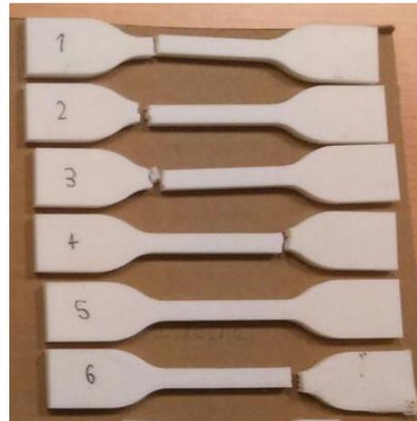
Figura 40-Probetas tracción: Escalado 17/10
