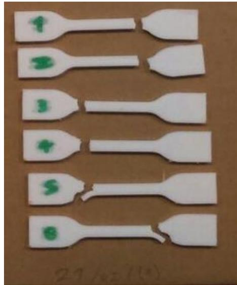
Figura 39-Probetas tracción: Relleno concéntrico
