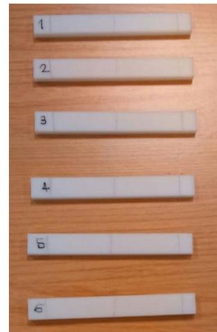
Figura 48-Probetas flexión: Material nuevo y posición de canto
