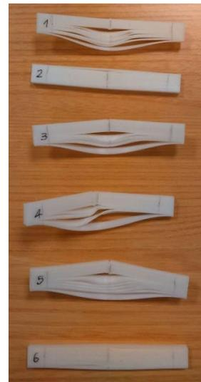
Figura 47-Probetas flexión: Material nuevo y relleno concéntrico
