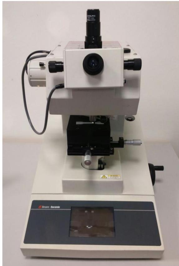
*Figura 2-Microdurómetro para ensayos de dureza Vickers*
