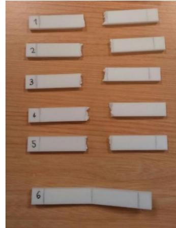
Figura 45-Probetas flexión: Curado (60°C, 5 horas)
