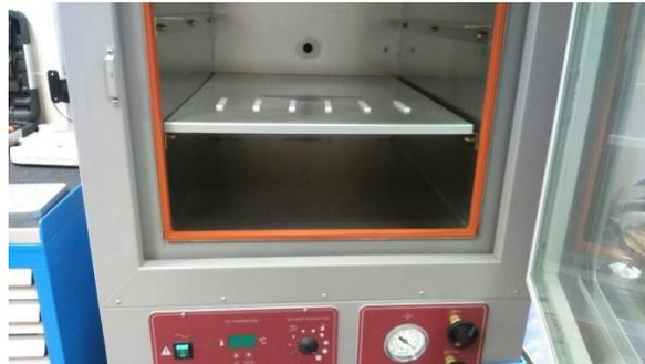
Figura 17-Horno empleado para el curado de las probetas (instalaciones del IAC)
