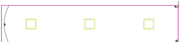
Altura del local: 3.000 m, Grado de reflexión: Techo 70.0%, Paredes 50.0%, Suelo 20.0%, Factor de degradación: 0.80
