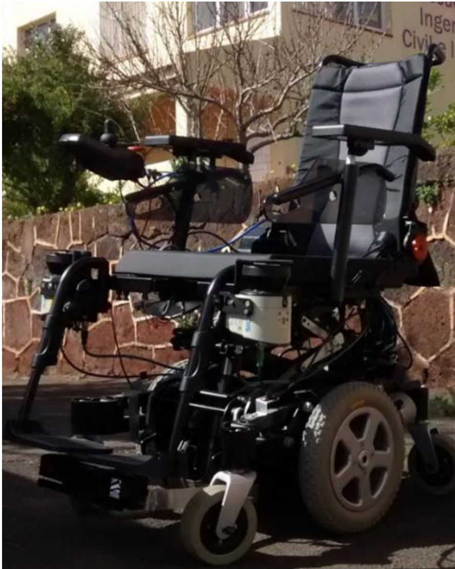
Figura 2, primera versión de la silla modificada con los distintos sensores
