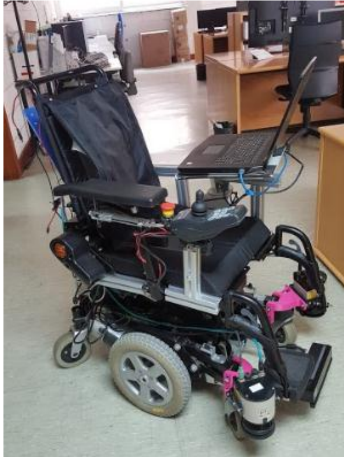
Figura 3, versión actual de la silla modificada con los distintos sensores
