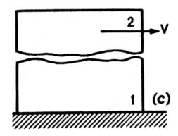
Ilustración nº 21: Engrase Seco o Rozamiento Sólido. Fuente: [10]
