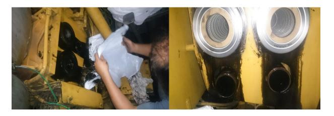
Ilustración nº 35: Sustitución filtros de aceite Vokes Simplex. Fuente: Trabajo de Campo.[9]
