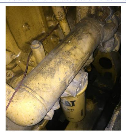
Ilustración nº 39: Enfriador de aceite y Filtro de aceite MM.AA. Fuente: Trabajo de Campo.[9]
