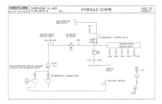
Ilustración nº 41: Esquema Circuito Lubricación Reductora Reintjes VLJ 6831 Fuente: Manual Reintjes. [17]
