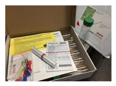
Ilustración nº 50: Instrumental Castrol para la recogida y envío de muestras de aceite.
