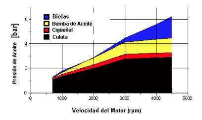
Gráfico nº 1: Relación Presión-velocidad para Lubricación hidrodinámica en partes del motor. Fuente: Recurso Web. [7]
