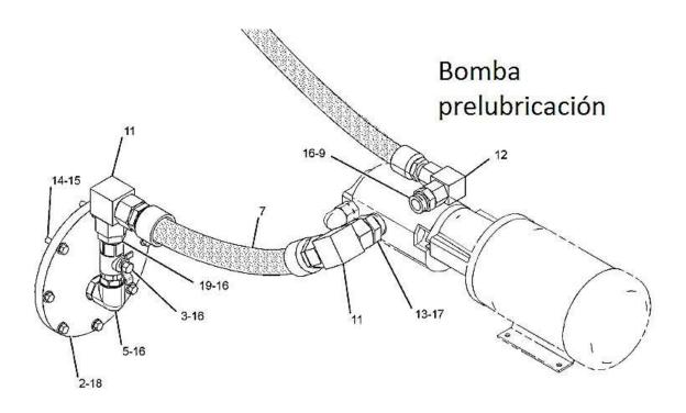
Ilustración nº 30: Bomba eléctrica de Pre-lubricación. Fuente: Manual de despiece. CAT 3618. [14]
