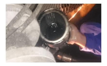
Ilustración nº 36: Comprobación de la Rejilla del Cárter. Fuente: Trabajo de Campo. [9]
