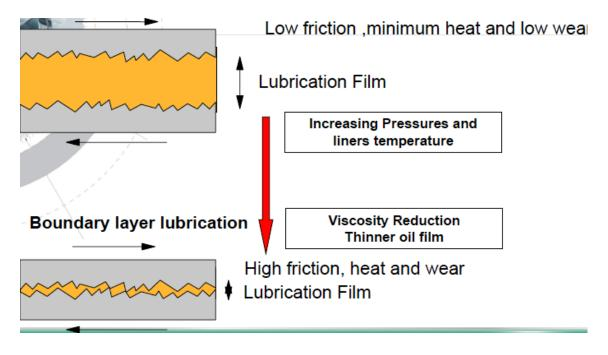
Ilustración nº 23: Esquema Lubricación hidrodinámica. Fuente: Seminario Castrol. [5]
