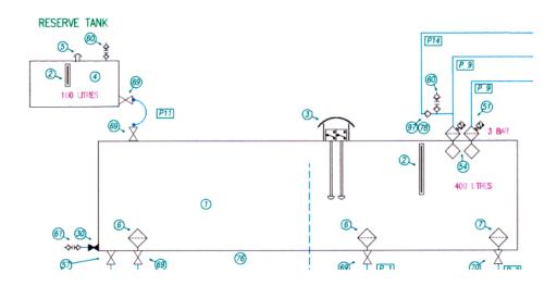
llustración nº 46: Esquema de los Tanques Hidráulicos.
