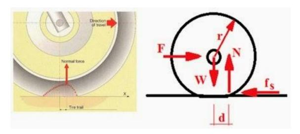
Ilustración nº 11: Fricción de Rodadura en cuerpos deformables. Fuente: Recurso Web. [7]
