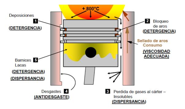
Ilustración nº 26: Funciones del Lubricante. Fuente: Seminario Castrol. [5]
