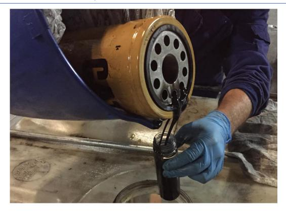
Ilustración nº 49: Recogida de muestra de aceite desde el filtro de MM.AA.
