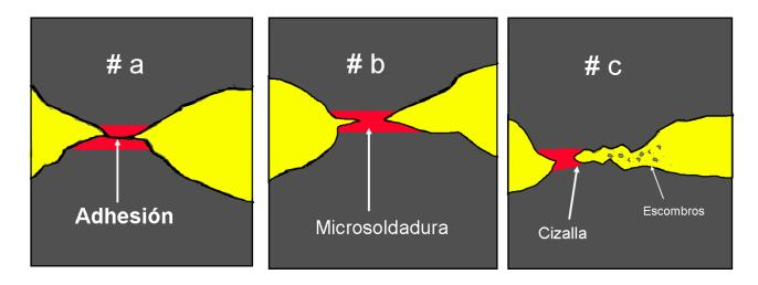
Ilustración nº 14: Estadios de un Desgaste Adhesivo. Fuente: Seminario Castrol. [5]
