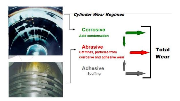
Ilustración nº 12: Tipos de desgaste. Fuente: Seminario Castrol. [5]
