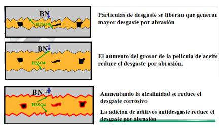
Ilustración nº 16: Esquema Desgaste Corrosivo. Fuente: Seminario Castrol. [5]
