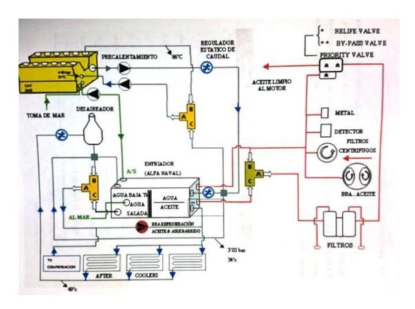
Ilustración nº 29: Circuito del Sistema de Iubricación de los MM.PP. Fuente: Manuales del Buque. [2]
