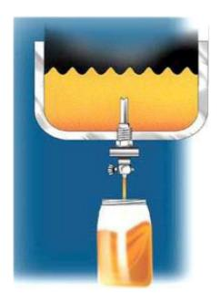
Ilustración nº 54: Procedimiento de toma de muestras en sistemas no circulantes.
