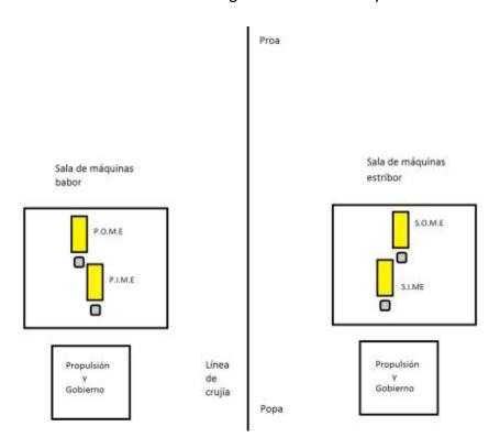
Ilustración nº 7: Distribución y nomenclatura de los MM.PP. Fuente: Esquema personal.
