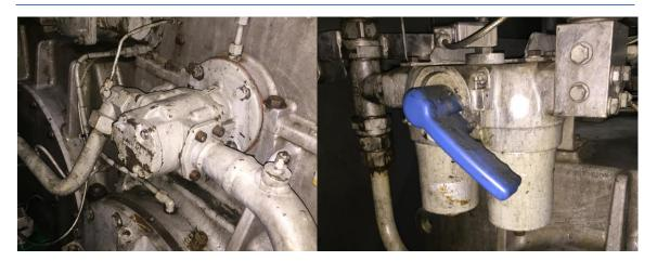
Ilustración nº 42: Bomba de Lubricación y Filtros Reductora Reintjes VLJ 6831.
