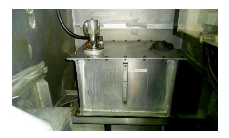
Ilustración nº 47: Tanque de reserva de la Unidad Hidráulica.
