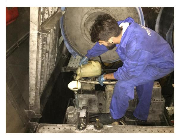
Ilustración nº 44: Reposición de aceite a Reductora Reintjes 6831. Fuente: Trabajo de Campo.[9]
