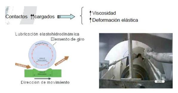
Ilustración nº 25: Esquema Lubricación Elasto-hidrodinámica. Fuente: Seminario Castrol.[5]
