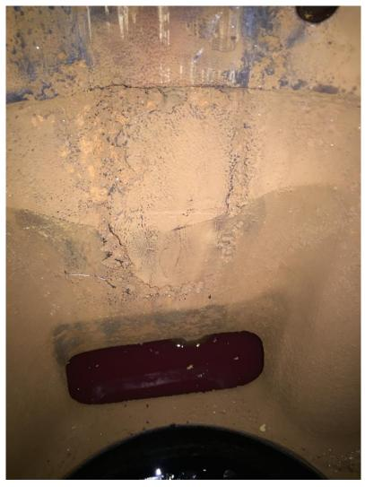
Ilustración nº 18: Cavitación en el Bloque Motor de Caterpillar 3618. Fuente: Trabajo de Campo. [9]
