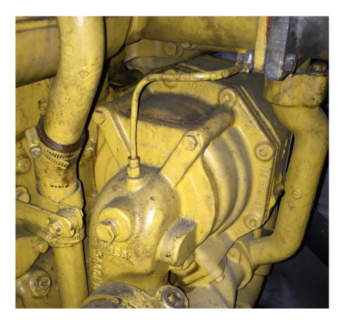
Ilustración nº 38: Bomba de Lubricación MM.AA. Fuente: Trabajo de Campo.[9]
