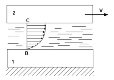
Ilustración nº 8: Esquema de rozamiento fluido. Fuente: Seminario Castrol.[5]
