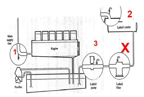
Ilustración nº 52: Recomendaciones en las tomas de muestras en motores diesel.
