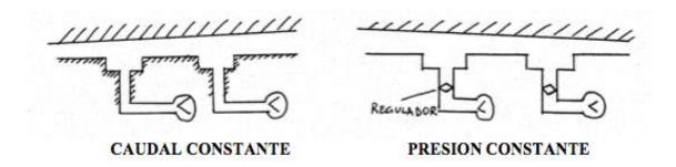
Ilustración nº 22: Tipos de cojinetes hidrostáticos. Fuente: [10]
