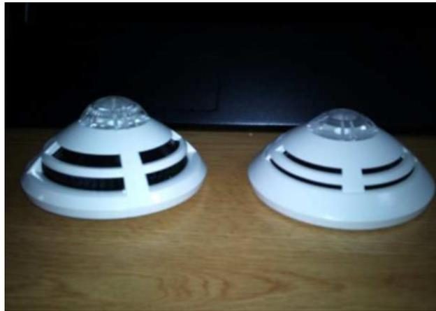
Ilustración 11. Detectores de humo/calor. Fuente: Trabajo de campo
