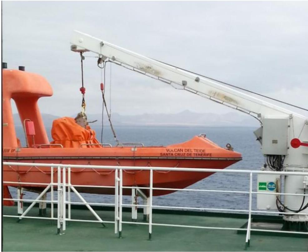
*Ilustración 59. Bote de rescate no rápido en su estiba. Fuente: Trabajo de campo*
