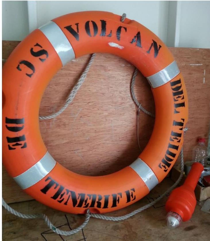
Ilustración 41. Aro salvavidas con luz de encendido automático. Fuente: Trabajo de campo
