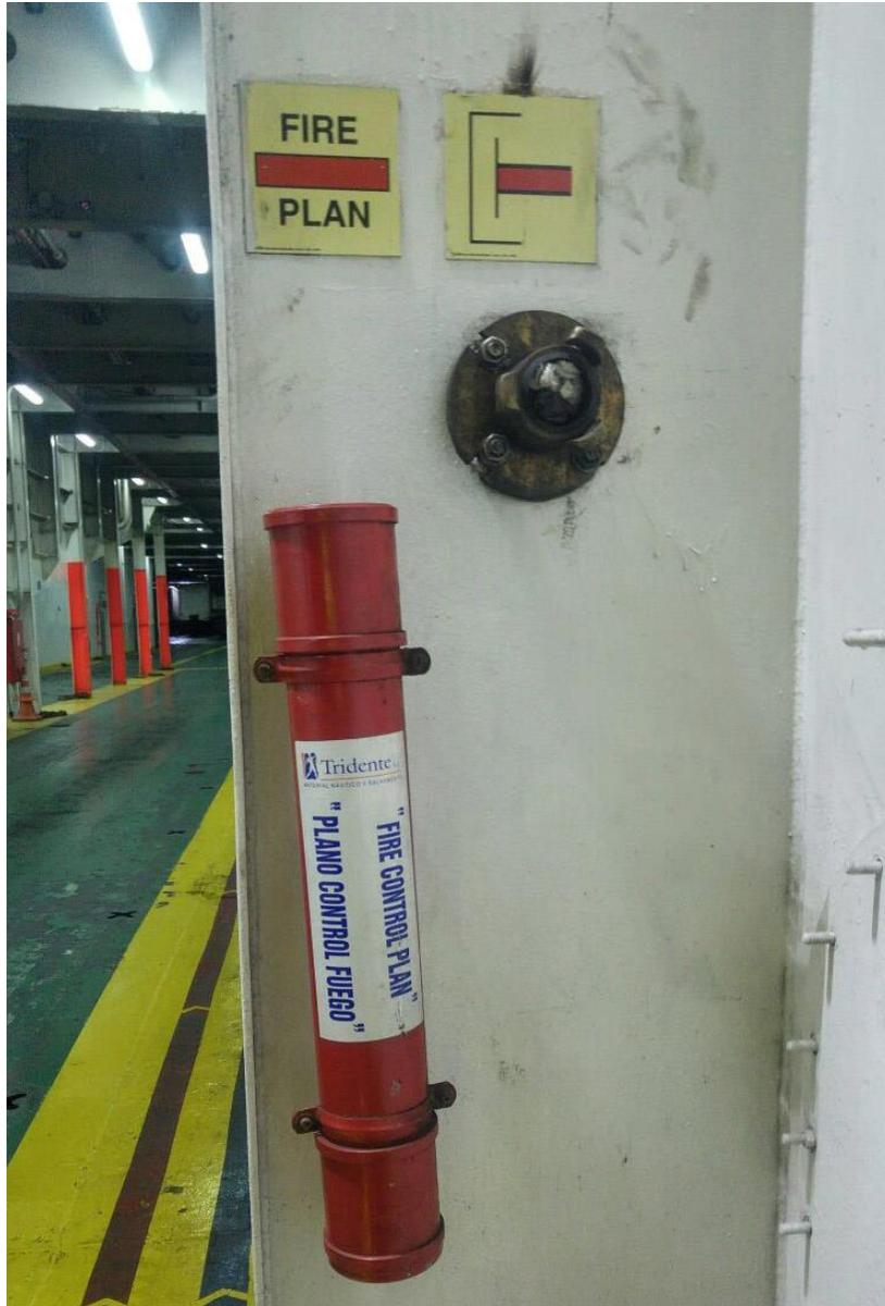
Ilustración 7. Fire plan cubierta 3 estribor y toma internacional a tierra. Fuente: Trabajo de campo
