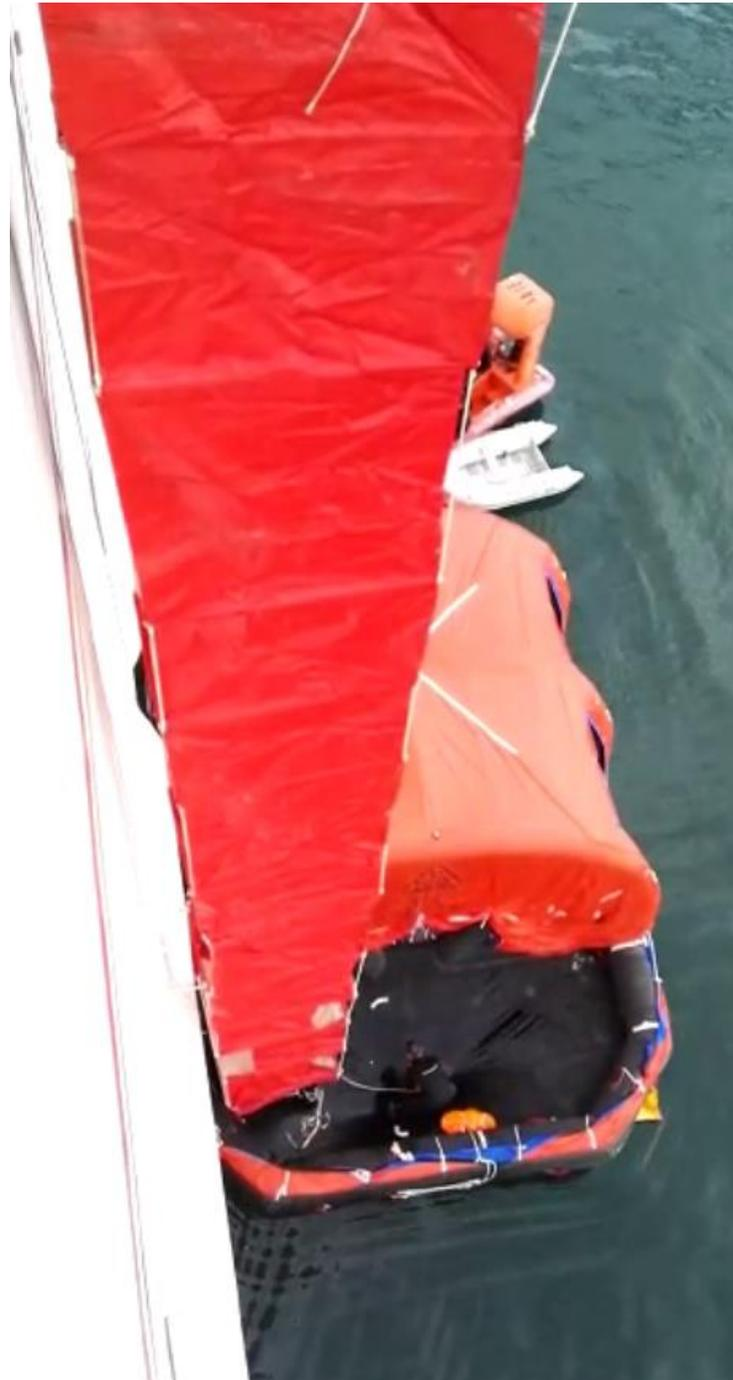
*Ilustración 61. Chute y balsa del MES. Fuente: Trabajo de campo*
