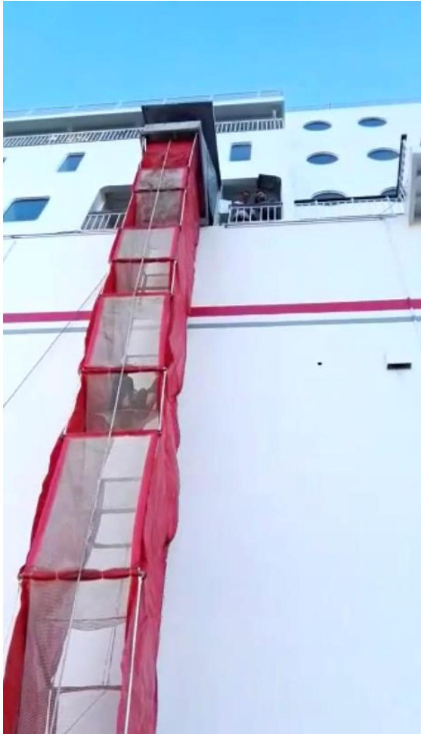
*Ilustración 60. Chute del MES. Fuente: Trabajo de campo*
