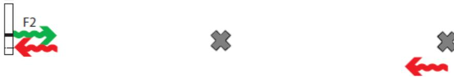
**T+12 microsegundos:** El primero eco de la frecuencia F1 llega al receptor. El eco del blanco 2 retorna al radar. Ahora el radar se encuentra transmitiendo a una frecuencia F2. Comparando F2 con f1 se clacula el intervalo de tiempo del blanco 1
