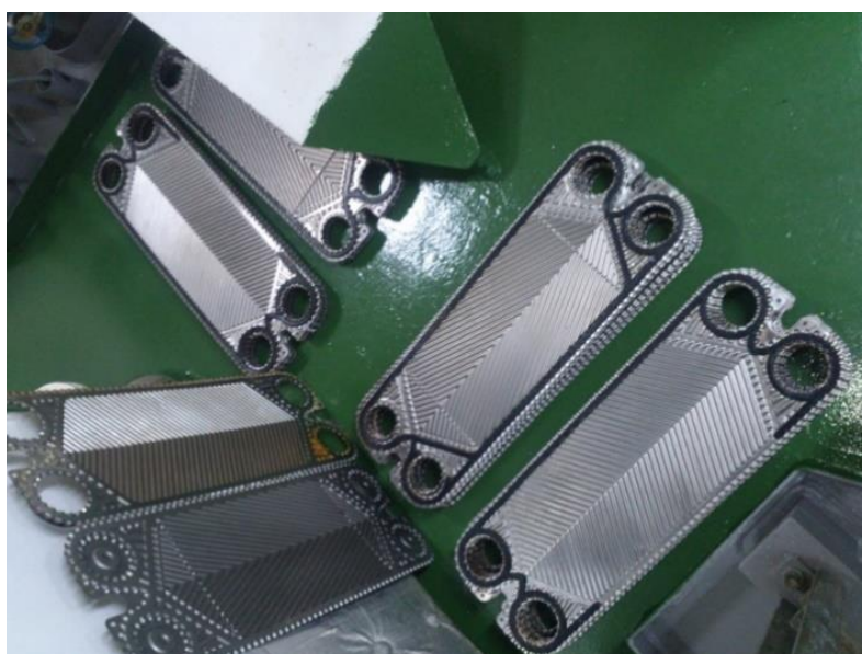
Fig. 67 Placas limpias y separadas por tipo
