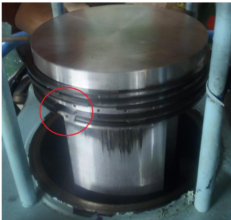
Fig. 75 Detalle corte segmento de engrase
