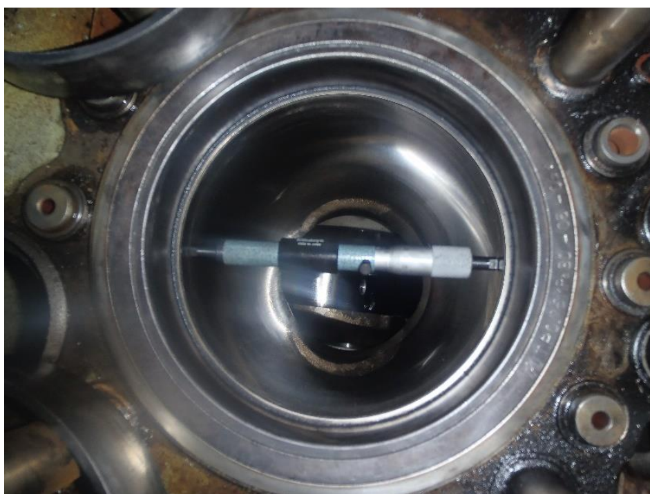
Fig. 91 Medición diámetro interior del cilindro
