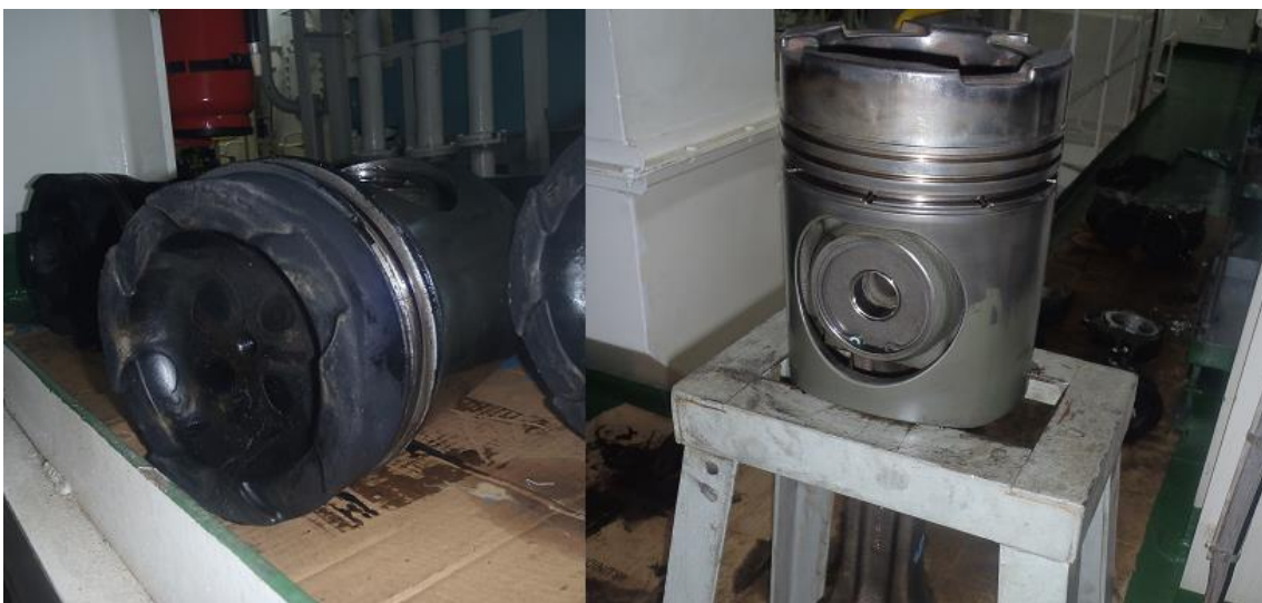
Fig. 88 Cabeza del pistón antes y después de la limpieza
