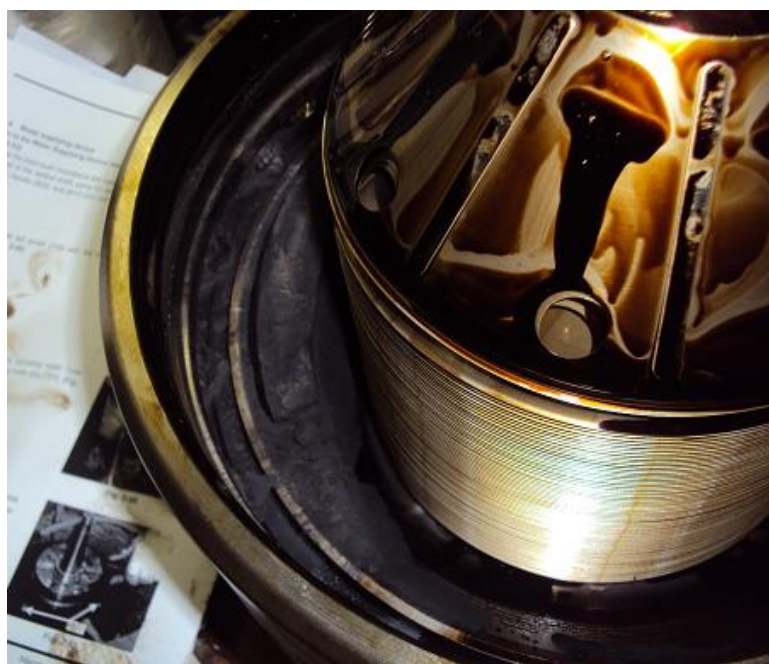
Fig. 79 Estado de los discos y bolo tras el desmontaje
