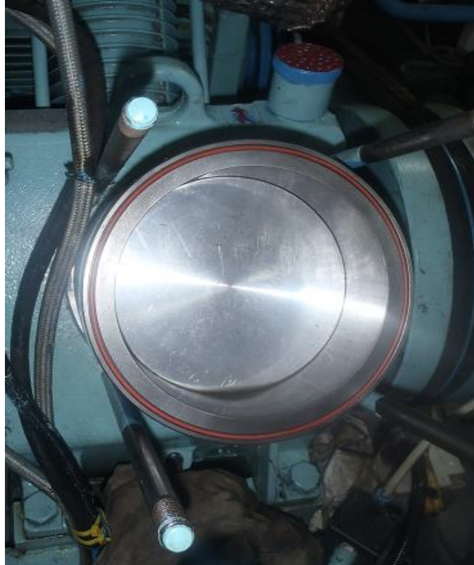
Fig. 76 Cilindro con junta tórica nueva
