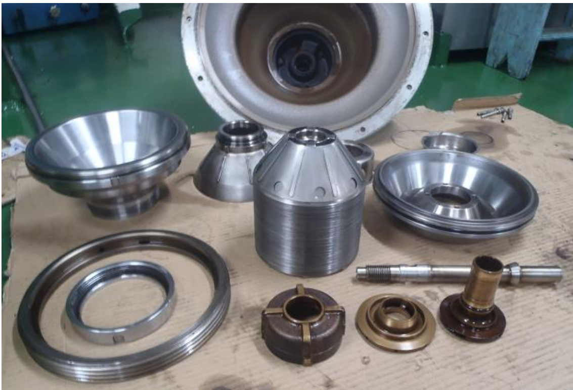
Fig. 80 Elementos limpios y listos para el montaje
