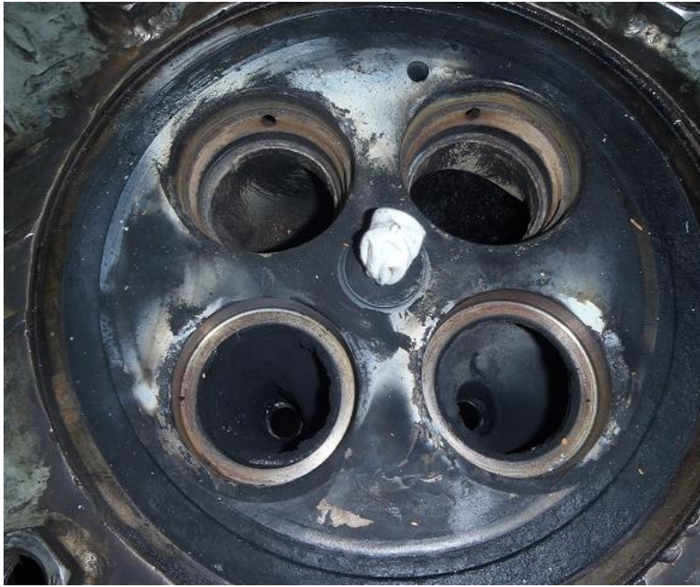
Fig. 87 Depósitos de hollín en cámara de combustión y conducto de escape
