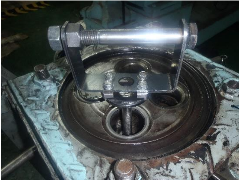
Fig. 92 Útil empleado para esmerilar válvulas
