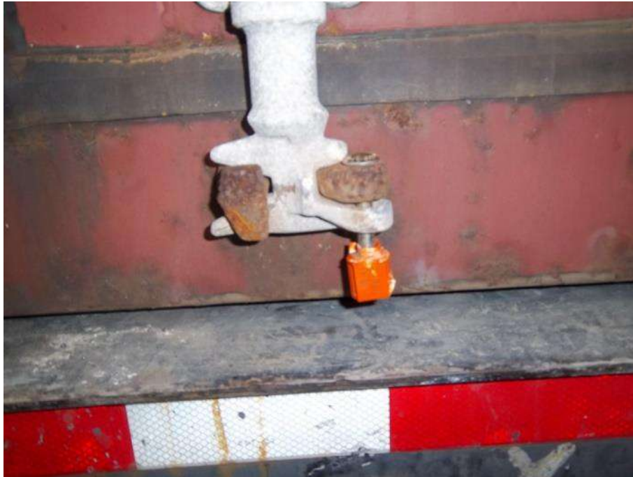
Ilustración 27. Sello de un contenedor. Fuente: Elaboración Propia.
