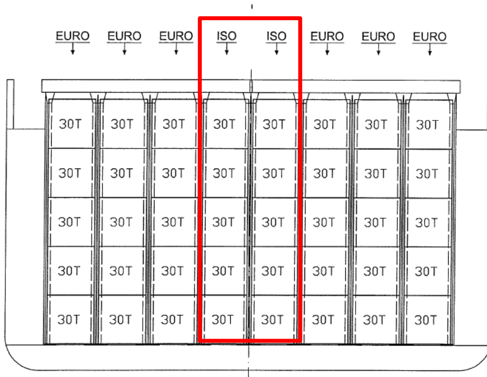
Ilustración 42 Disposición general de contenedores ISO y EURO (Anchos) en la bahía 16 Fuente: Manual de Estiba editado.
