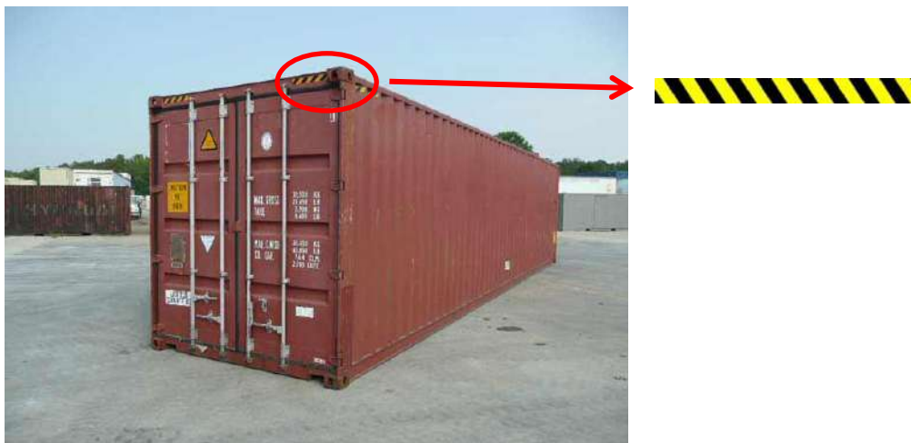
Ilustración 46 Contenedor High Cube. Fuente: Trabajo de Campo
