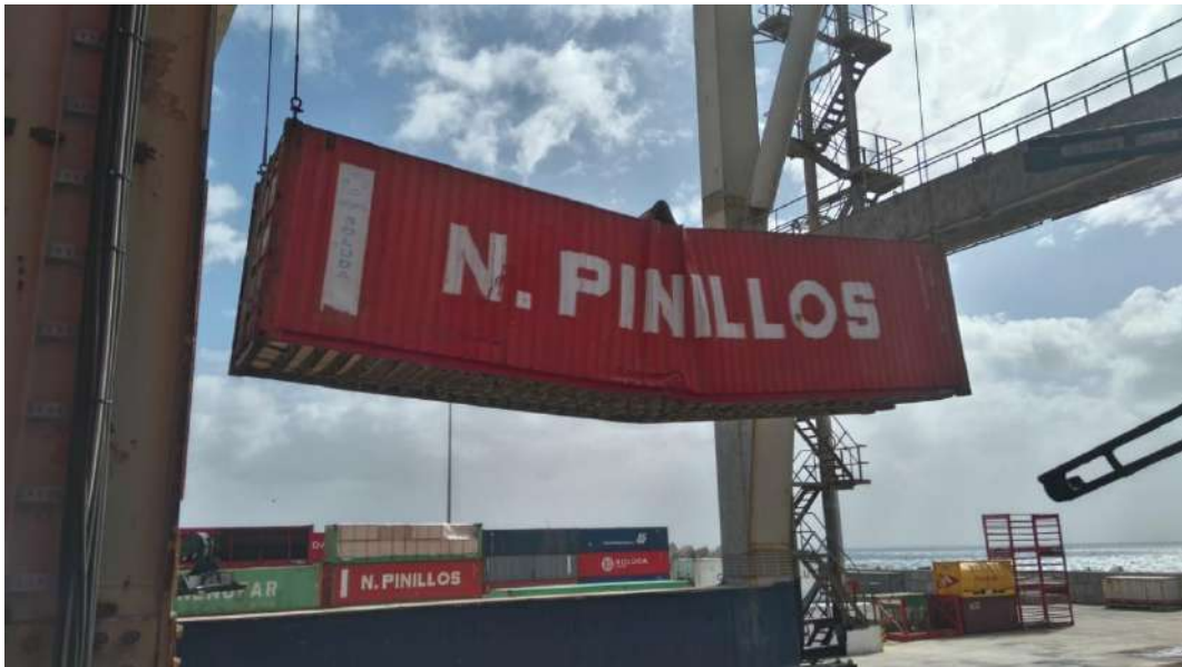
Ilustración 91 Avería de un contenedor en Puerto Rosario. Fuente: Trabajo de Campo.
