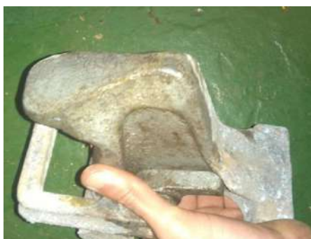
Ilustración 62 Pin pico de loro, plano y foto. Fuentes: Trabajo de campo y Documento del Beatriz B
