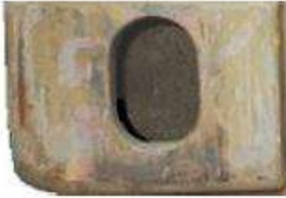
Ilustración 28 Dado ISO. Fuente: Alejandro López González "El contenedor, La terminal y métodos Informáticos"
