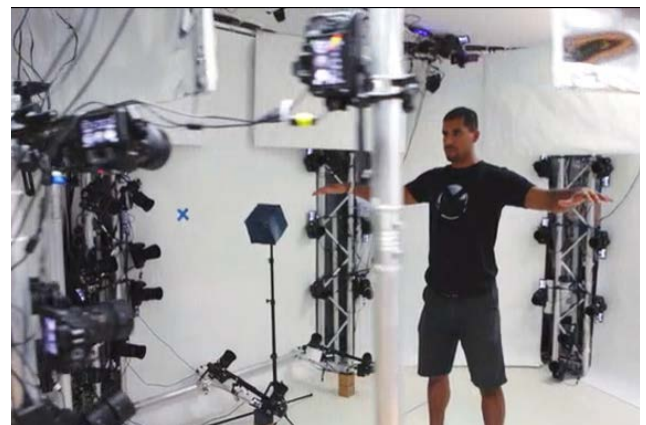
Imagen 39: Escáner fotográfico xxArray
