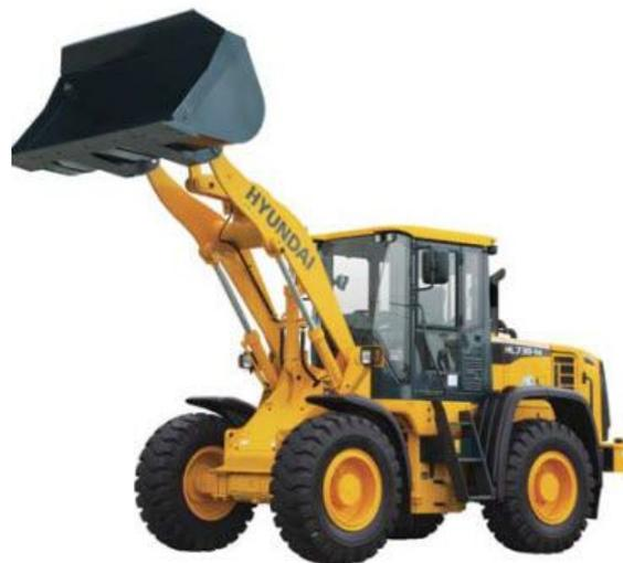
Estas palas tiene una generación de ruido baja y servirán no sólo para transportar directamente la materia prima o el producto de un punto a otro de la planta, sino que, si se cambia la pala principal adaptable, puede cargar pesos elevados como los contenedores de impropios que se producen en la planta. A continuación se muestra en la Tabla D19.2 las características.
