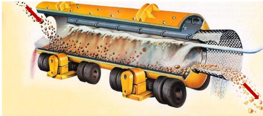
Ilustración D18.5. Criba giratoria, carcasa y parte interna.
