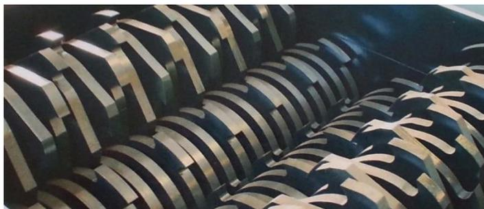
*Figura 7.1. Vista de las cuchillas para la trituración de NFU [13A]*
