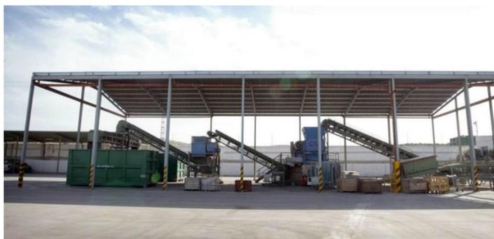
*Figura 7.2. Vista lateral de un tren de trituración de NFU para conseguir granulado fino. [13B]*
