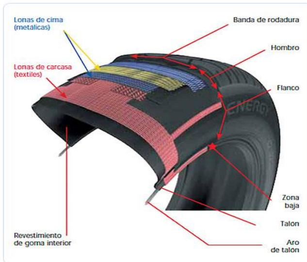
Figura 4.1 Diagrama de un neumático con sus partes. <sup>[3]</sup>
