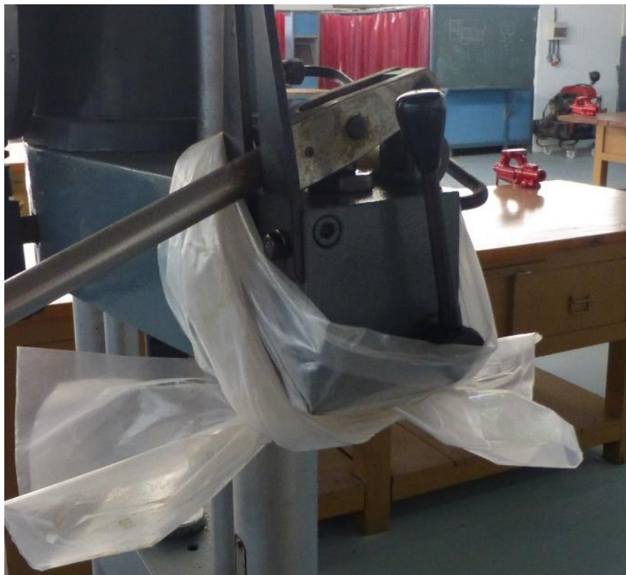
Figura 19. Bloque de bombeo recubierto para evitar el derrame de aceite. Fuente: Propia
