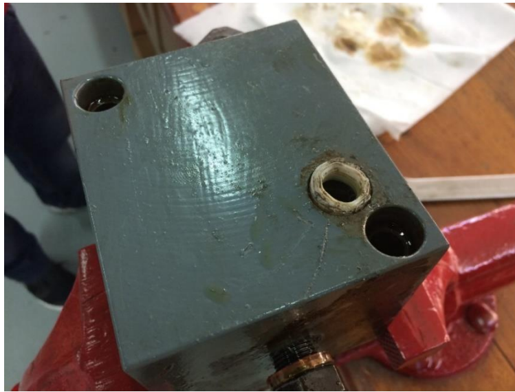
Figura 22. Sello hidráulico en mal estado. Fuente: Propia
