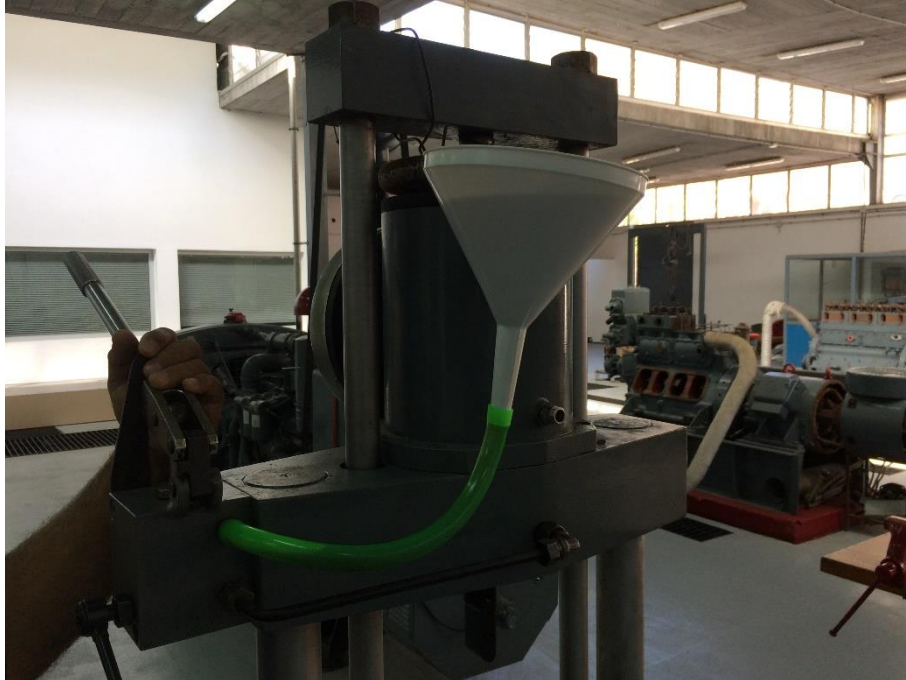
Figura 28. Sistema utilizado para la reposición de aceite. Fuente: Propia
