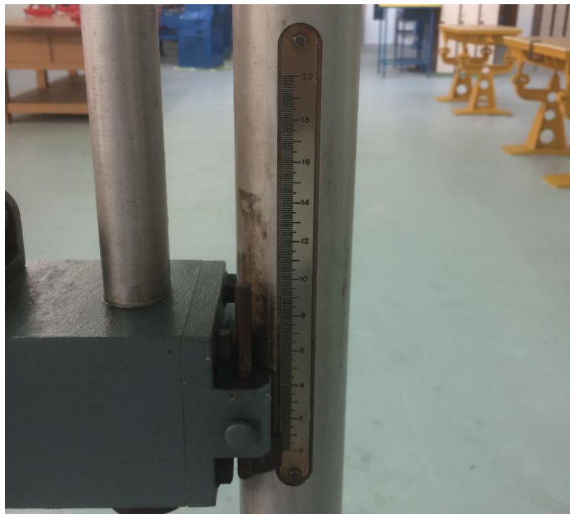
Figura 16. Regla de medición del desplazamiento del pistón. Fuente: Propia
