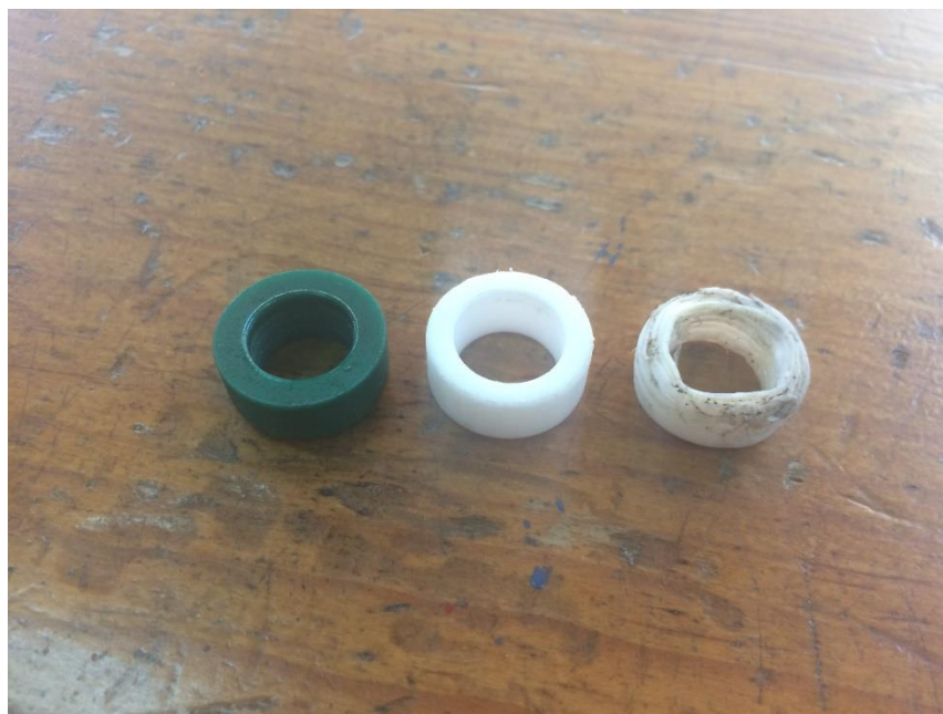
Figura 25. Sellos hidráulicos (PU a la izquierda, PTFE a la derecha y en el centro). Fuente: Propia
