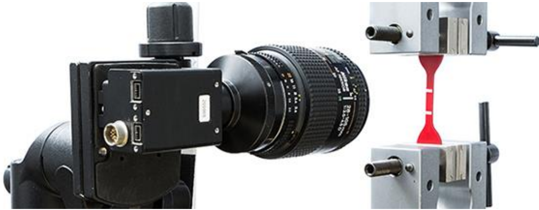
Figura 5. Medición de deformación lineal mediante captura de vídeo. Fuente: www.ametektest.com
