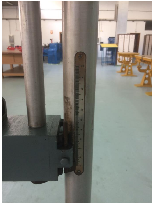
Figura 7. Regla de medición del desplazamiento del pistón. Fuente: Propia
