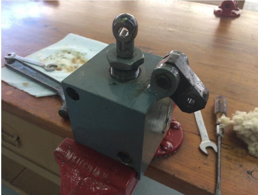
Figura 20. Extracción del cilindro-pistón de bombeo. Fuente: Propia
