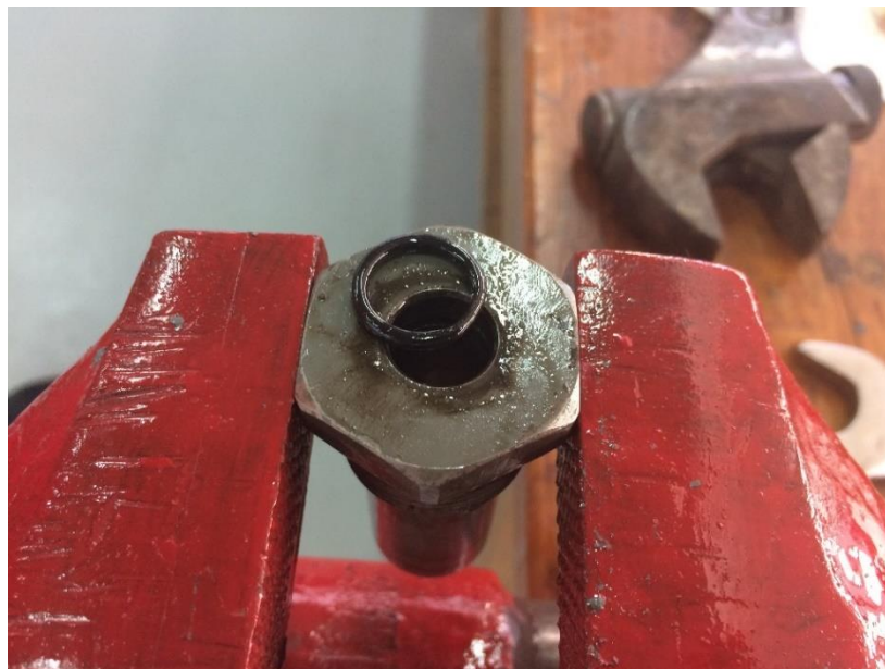
Figura 21. Junta tórica interna del cilindro-pistón de bombeo. Fuente: Propia
