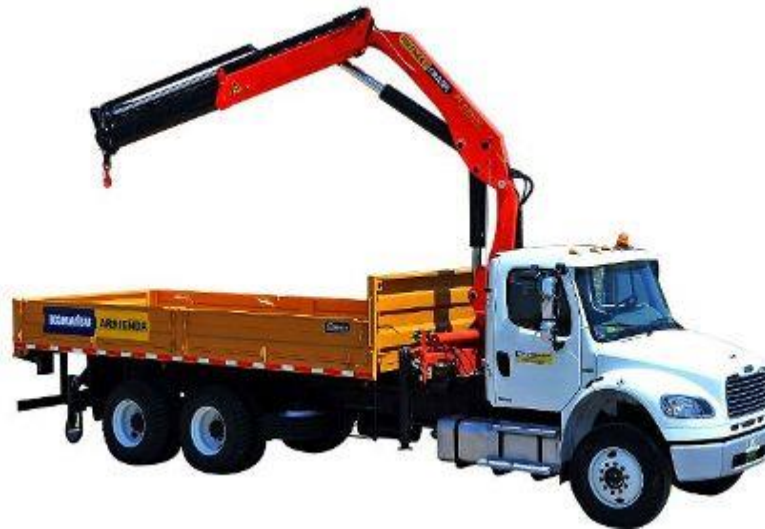
Grúa con actuadores hidráulicos instalada entre la cabina y la caja de la furgoneta o camión.
