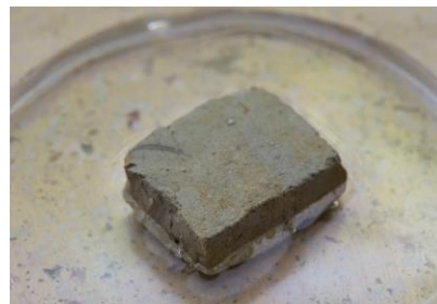
Figura 58. Probeta con consolidante en ensayo de absorción forzosa. Paraloid B72 al 5% en Acetona.
