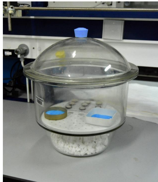
Figura 53. Desecador con muestras en polvo y sulfato de cobre.
