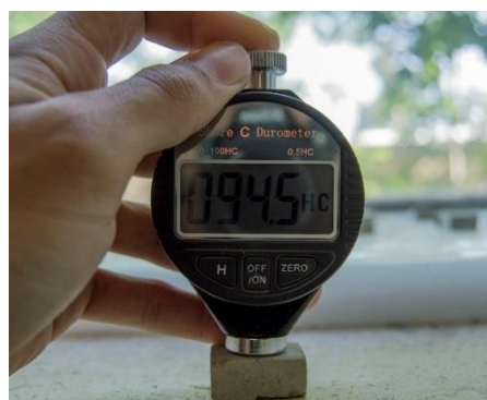
Figura 48. Medida de dureza con durómetro.
