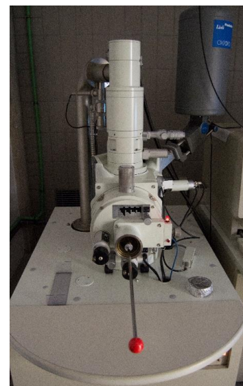
Figura 23. JEOL JSM 63000 (SEM) con Microanalizador acoplado de Energías Dispersivas de Rayos X (EDX) Oxford 6699 ATW.
