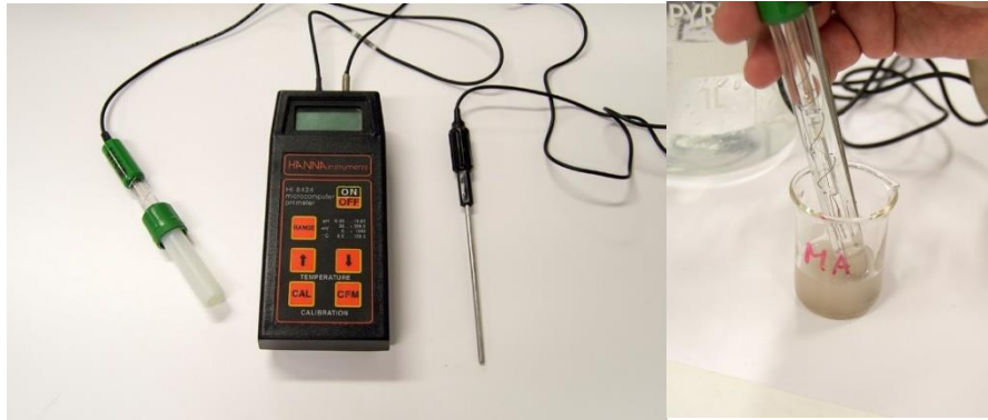
Figura 17. pH-metro con celda y sonda de temperatura (izquierda). Medición de pH de la solución de arcilla de muestra MA (derecha).
