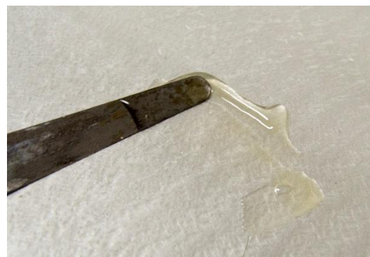
Figura 103. Aplicación del adhesivo.
