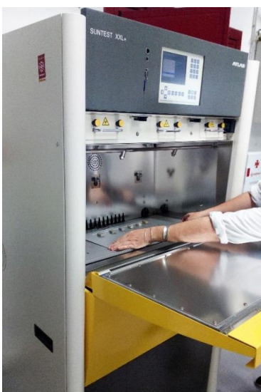
Figura 46. Introducción de probetas en la cámara de envejecimiento controlado.
