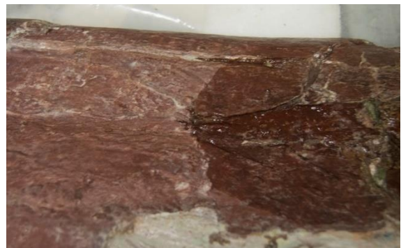
Figura 86. Diferencia en parte no consolidada (izquierda) y parte consolidada (derecha).
