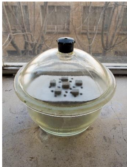
Figura 51. Cámara de humedad.
