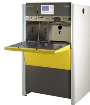
Figura 45. Cámara de envejecimiento acelerado. Arco-Xenón Suntest XXL+
