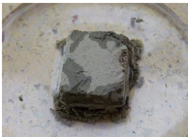
Figura 57. Probeta con consolidante en ensayo de absorción forzosa. Nano Estel prop. 1:1.
