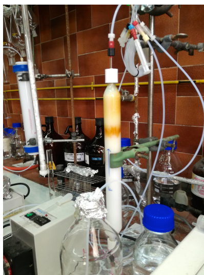
Figura 22. Ejemplo de separación en columna de media presión en fase reversa
