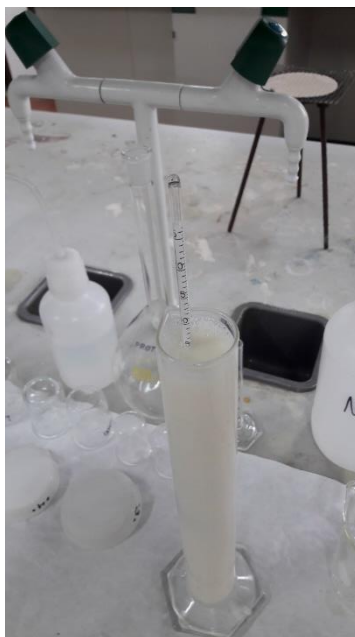
Figura III.3. Imagen del lactodensímetro introducido en la probeta que contiene la muestra de leche.
