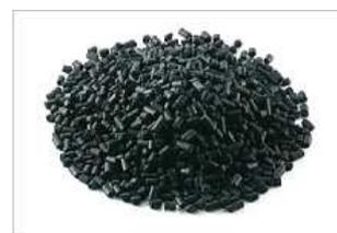
Figura 5. Pellet de tamiz molecular de carbón<sup>14</sup>
