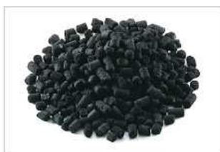
Figura 4. Pellet de carbón activado<sup>13</sup>
