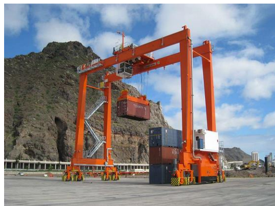
Ilustración 2. Grúa transtainer cargando contenedor
