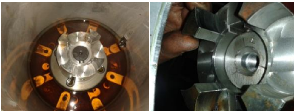
Ilustraciones 115 y 116: Acoplamientos entre la bomba hidráulica y el motor eléctrico Fuente: Trabajo de campo
