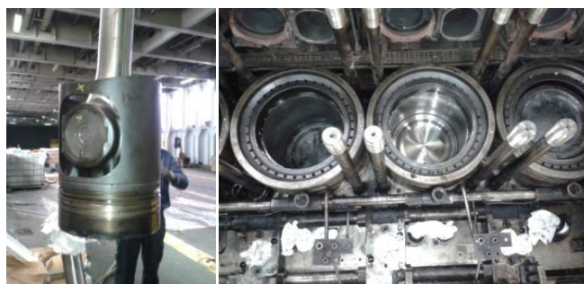
Ilustraciones 117 y 118: Montaje de pistones ya reacondicionados Fuente: Trabajo de campo
