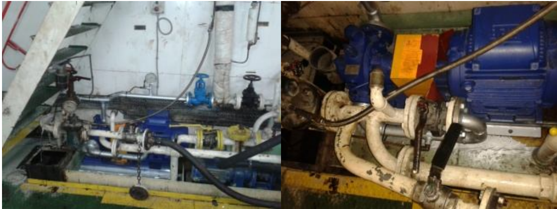
Ilustraciones 106 y 107: Bomba achique de sentinas y lodos Fuente: Trabajo de campo
