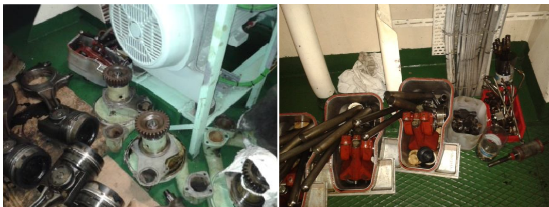
Ilustraciones 52 y 53: Pistones, bombas acopladas de agua, balancines y tapa de balancines. Fuente: Trabajo de campo
