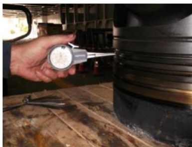
Ilustración 47: Medición de cajas Fuente: Trabajo de campo
