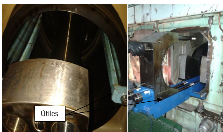
Ilustraciones 68 y 69: Extracción cojinetes cabeza de biela Fuente: Trabajo de campo
