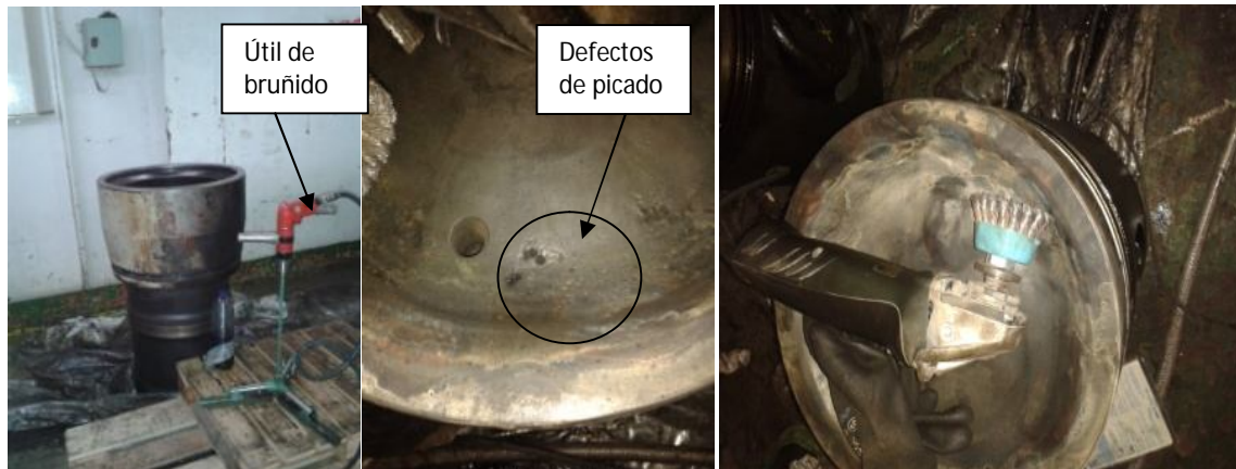
Ilustraciones 89, 90 y 91: Camisa y Cabeza pistón Fuente: Trabajo de campo
