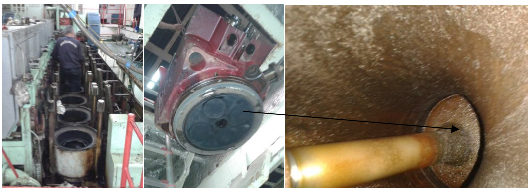
Ilustraciones 30, 31 y 32: Vista de proa del motor principal, izado de una culata a una cubierta superior para su posterior reacondicionamiento y vista inferior de una válvula de gases de escape Fuente: Trabajo de campo
