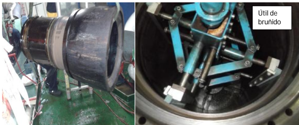
Ilustraciones 84 y 85: Izado de camisas y bruñido de camisas. Fuente: Trabajo de campo
