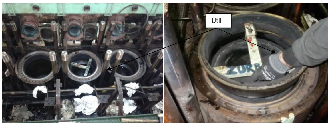
Ilustraciones 42 y 43: Desmontaje de los 9 aros anti-desgaste. Fuente: Trabajo de campo
