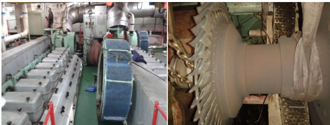
Ilustraciones 87 y 88: Vista del despiece del turbocompresor y Corona lado gases de escape . Fuente: Trabajo de campo
