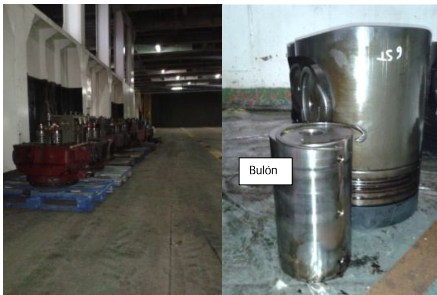
Ilustraciones 81 y 82: Culatas y despiece de los pistones. Fuente: Trabajo de campo
