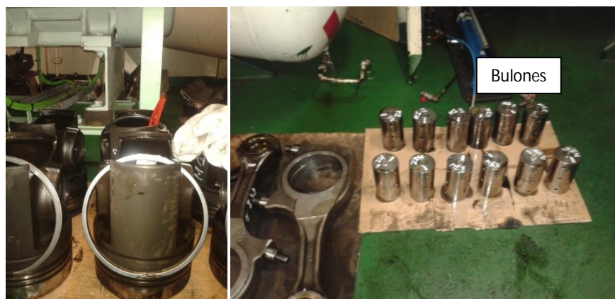
Ilustraciones 64 y 65: Despiece de los pistones de los motores auxiliares Fuente: Trabajo de campo
