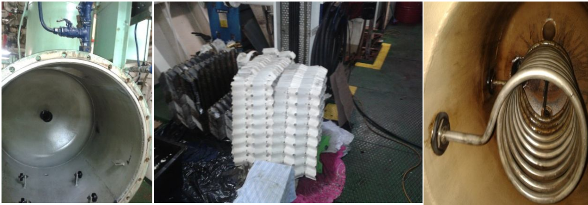
Ilustraciones 61, 62 y 63: Interior del separador de sentina, placas filtrantes y serpentín Fuente: Trabajo de campo
