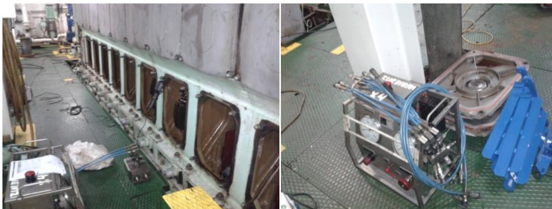
Ilustraciones 58 y 59: Tapas de registro del cigüeñal y bomba hidráulica más útiles para desmostar cojinetes
