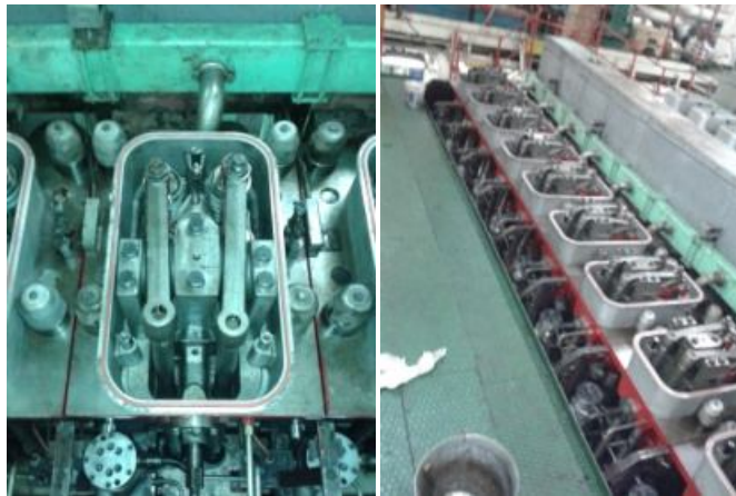
Ilustraciones 123 y 124: balancines y Vista motor principal ya reacondicionado Fuente: Trabajo de campo
