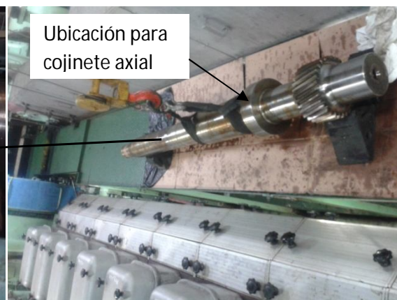
Ilustración 9: Eje de la reductora Fuente: Trabajo de campo
