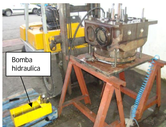
Ilustración 33: Prueba hidráulica de una delata culatas Fuente: Trabajo de campo
