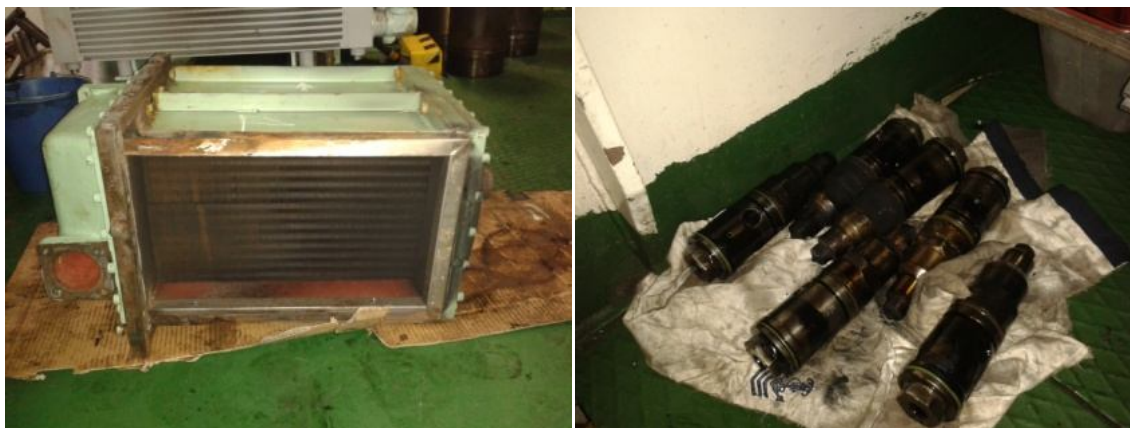
Ilustraciones 50 y 51: Enfriador de aire e inyectores después de extraerlos. Fuente: Trabajo de campo
