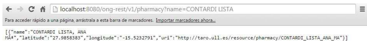
Figura 4.4. Llamada al servicio de farmacias para obtener la información de la misma
