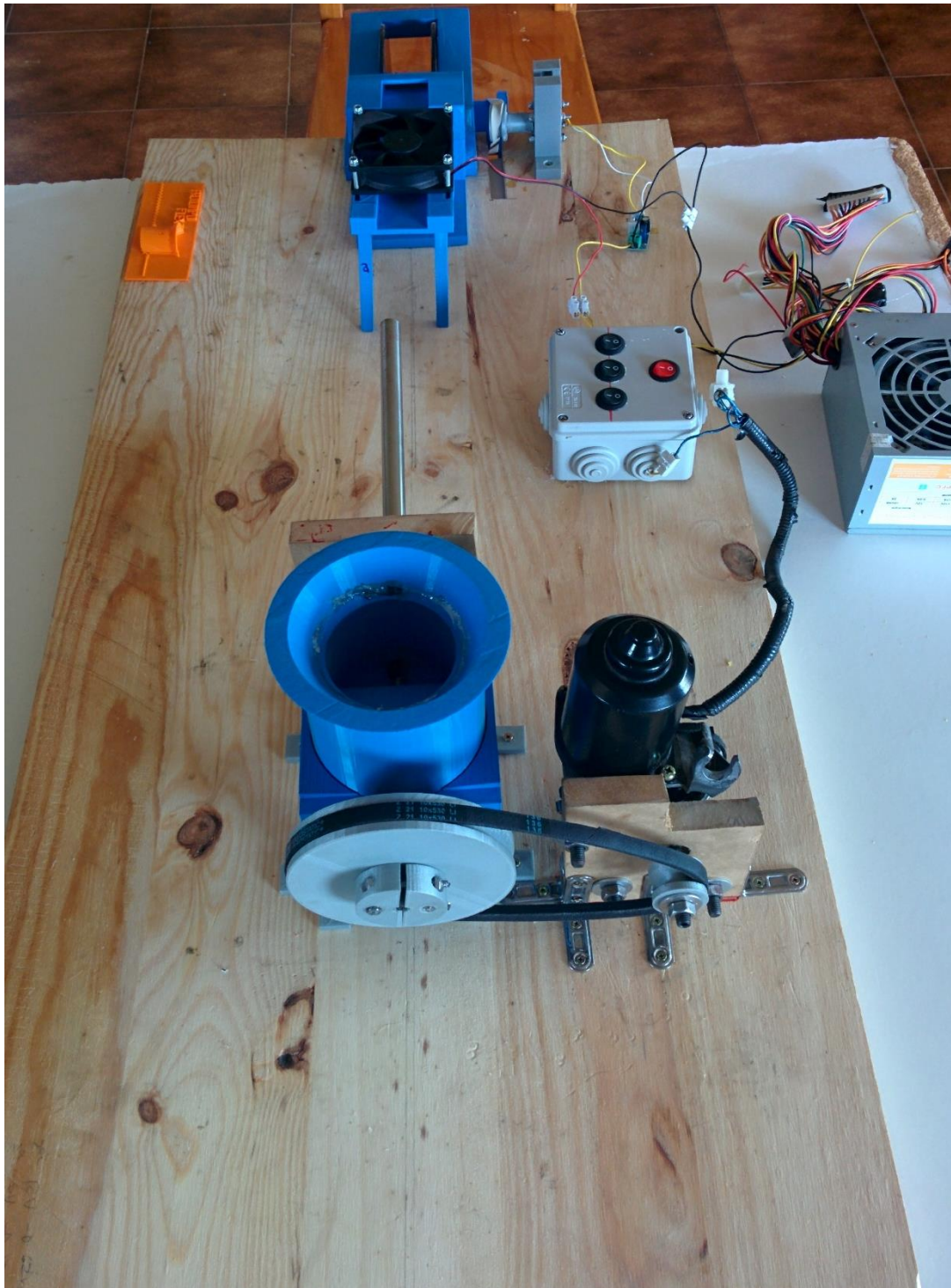
Figura 71. Montaje extrusora con conexiones eléctricas. Fuente: Propia.
