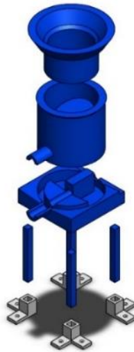
Figura 38. Vista explosionada tolva. Fuente: Propia.
