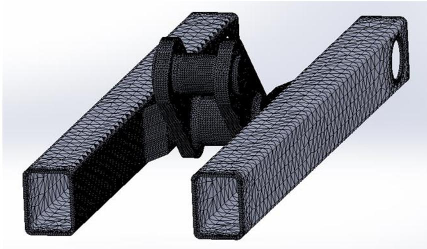
Figura 2.83 MODELO DE ESTUDIO PARA LA UNIÓN DE LA SUJECIÓN SUPERIOR CON LAS BARRAS, APLICADO REFUERZO Y MALLADO (Fuente: Propia).
