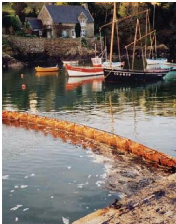
Ilustración 8. En el entorno portuario es común encontrar barreras de valla, fijas, usadas para desviar la contaminación de los buques y embarcaciones a lugares de mejor recolección. Fuente: itopf.com
