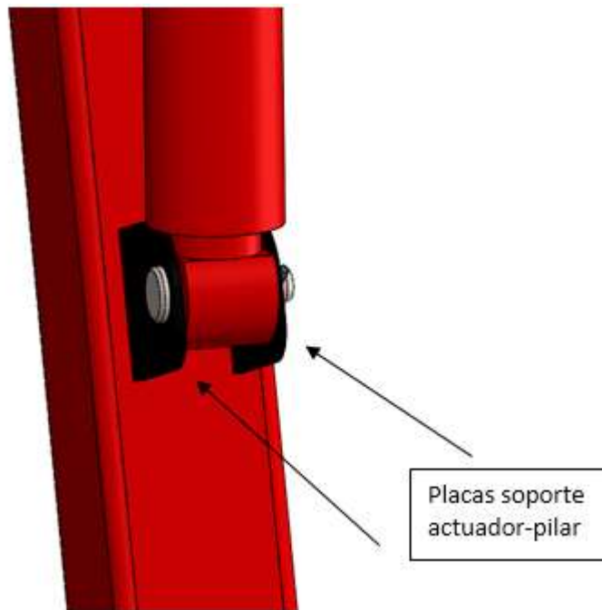
Figura 47. Situación de las placas unión actuador-pilar.
