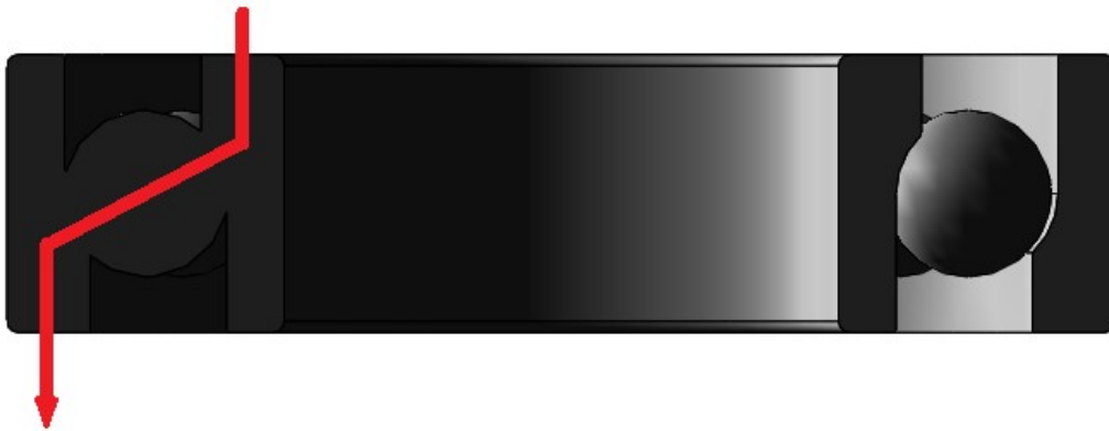
Figura 64. Transmisión de fuerza axial a través de las bolas del rodamientos.
