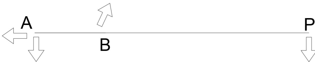
Figura 95. Representación de las fuerzas y reacciones para la pluma horizontal.
