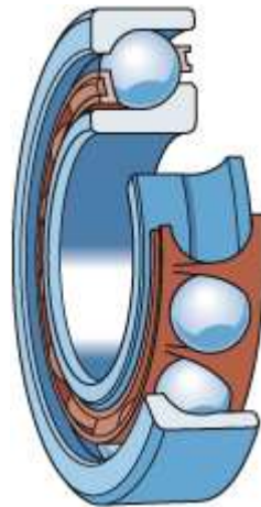
Figura 106. Vista de corte del rodamiento de bolas de contacto angular SKF.
