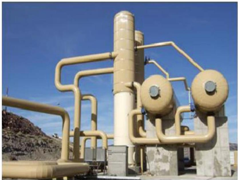
**Fig. 9** Esquema y foto de separador vertical [13]
