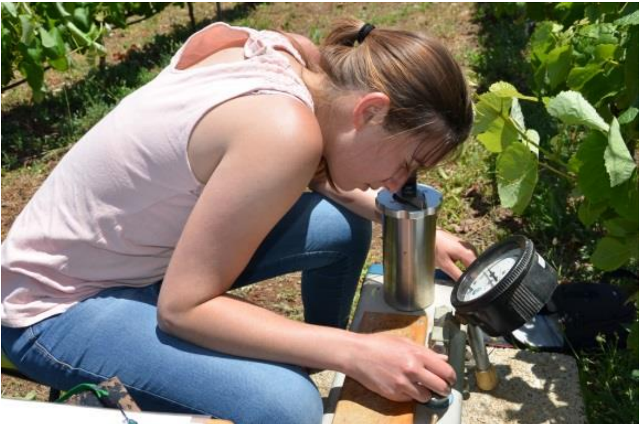
Fotografía 13: Medición del potencial hídrico mediante cámara de Schölander
