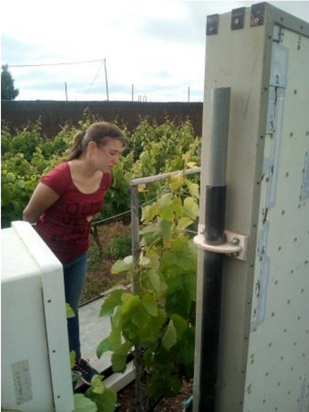
Fotografía 11: Panel para la medida de la distribución foliar por el método Points-Quadrates.
