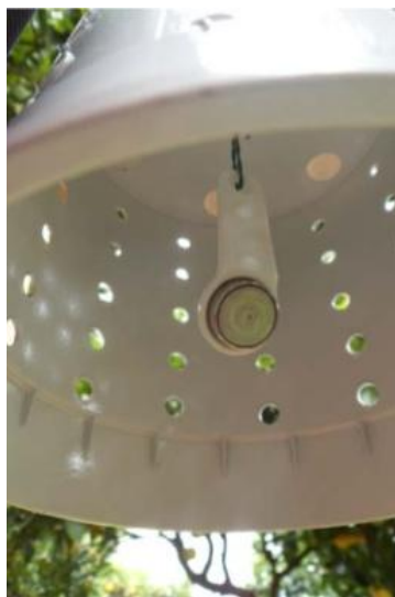
Figura 4 Datalogger iButton DS 1923 con protección de lluvia
