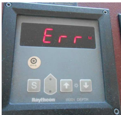
Ilustración 43. Repetidor de la señal del ecosonda de la zona de gobierno Fuente: Trabajo de campo
