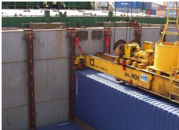
Ilustración 21. Detalle de las guías de un buque portacontenedores.
