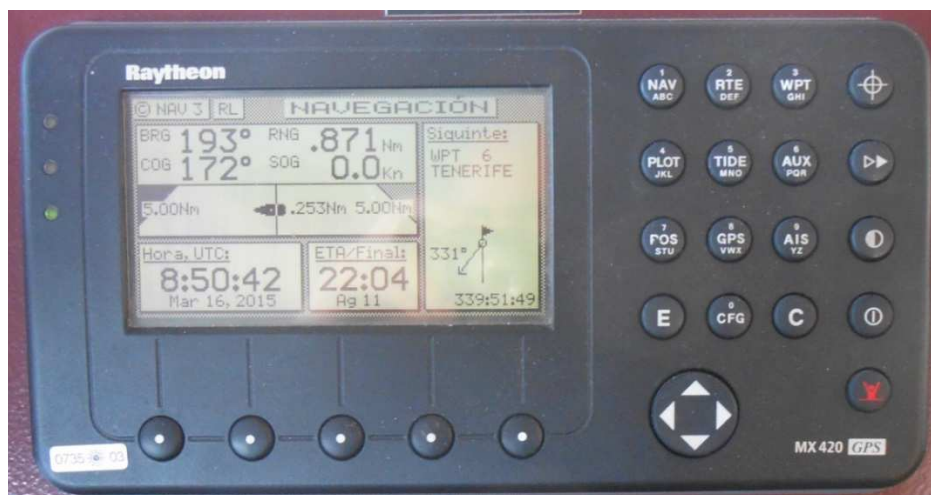
Ilustración 58. Equipo GPS MX420 ubicado en el gobierno del buque Fuente: Trabajo de campo
