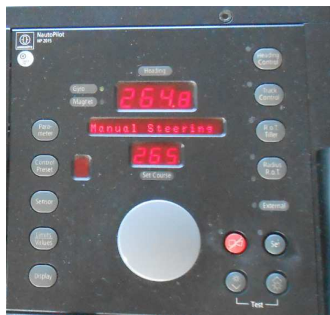
Ilustración 60. Panel del piloto automático NP2015 Fuente: Trabajo de campo
