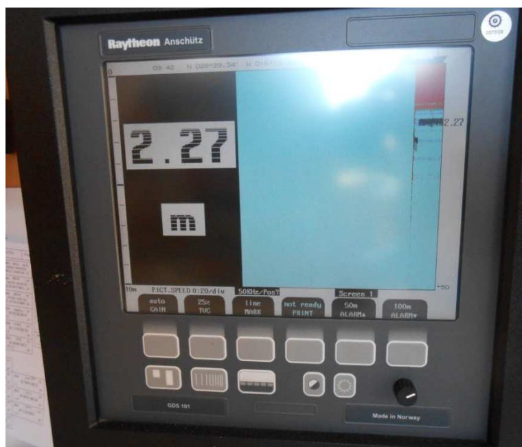
Ilustración 44. Ecosonda GDS 101 de la marca Raytheon Anschütz de la derrota Fuente: Trabajo de campo
