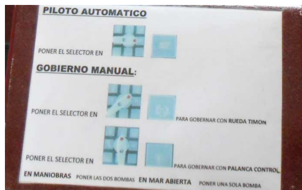
Ilustración 61. Selector del tipo de gobierno Fuente: Trabajo de campo
