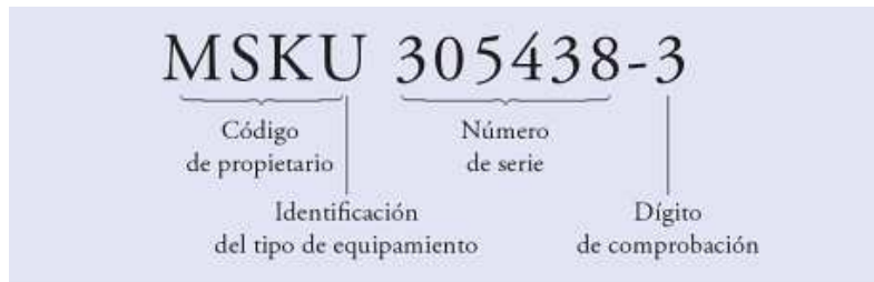
Ilustración 17. Ejemplo de código identificativo de contenedores.
