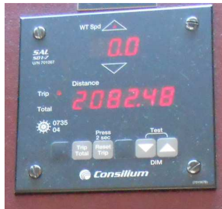
Ilustración 48. Repetidor de la corredera. Fuente: Trabajo de campo
