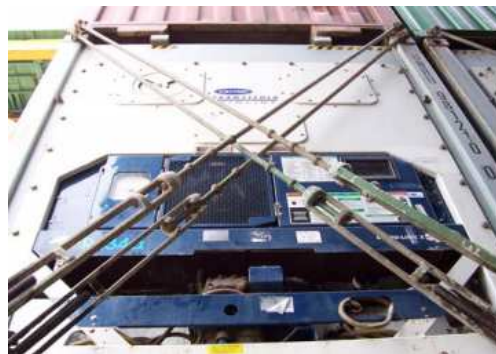
Ilustración 23. Trincas aplicadas a un contenedor. Fuente: Universidad de Cantabria [23]
