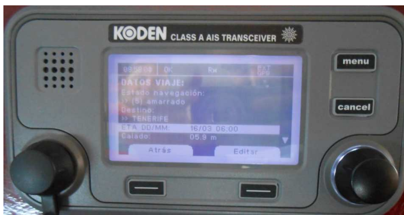
Ilustración 59. Transpondedor AIS de la clase A de la marca Koden Fuente: Trabajo de campo
