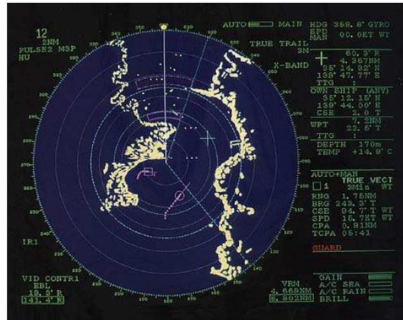
Ilustración 30. Pantalla de un ARPA Fuente: Temasafety [28]
