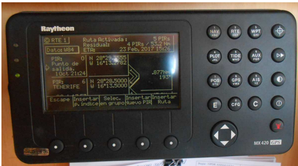
Ilustración 57. Equipo GPS MX420 ubicado en la derrota del buque Fuente: Trabajo de campo
