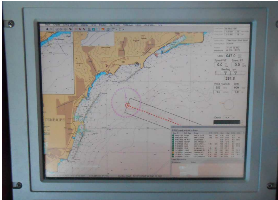
Ilustración 65. ECDIS Raytheon de la zona de gobierno Fuente: Trabajo de campo
