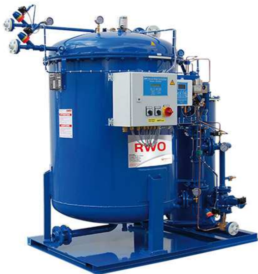
Figura 18 – Vista real de un separador de placas paralelas.
