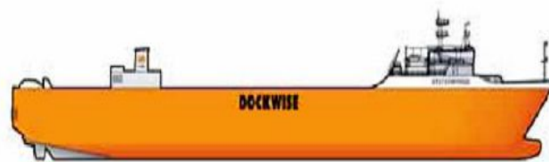
Buque semisumergible tipo dique. Fuente: Gregory Colomar Lix. Los semisumergibles de carga pesada.
