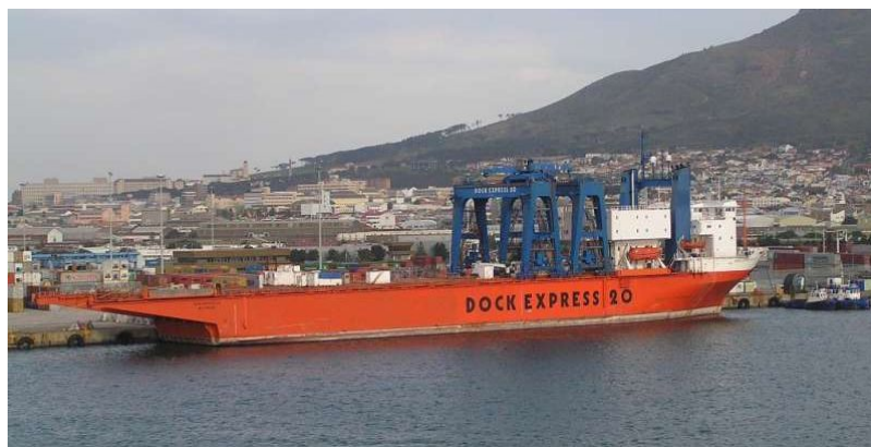
Semisumergible con grúas propias. Fuente: Gregory Colomar Lix. Los semisumergibles de carga pesada.
