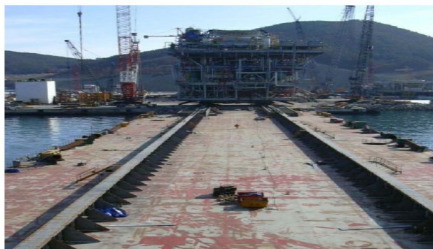
Embarque de forma deslizada. Fuente: Gregory Colomar Lix. Los semisumergibles de carga pesada.
