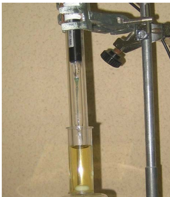
Figura 3.6 Sensor amperométrico Unisense ® introducido en la célula de trabajo
