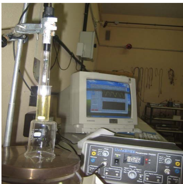
Figura 3.9 Montaje de las medidas amperométricas en disolución, instalado en nuestro laboratorio
