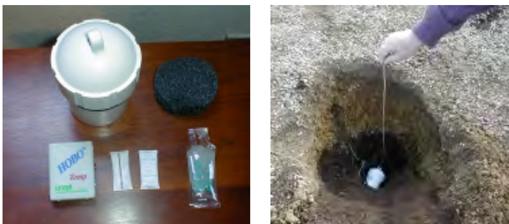
Figura 3 Sensor HOBO H8 junto a distintos accesorios y detalle de un emplazamiento a 50 cm
