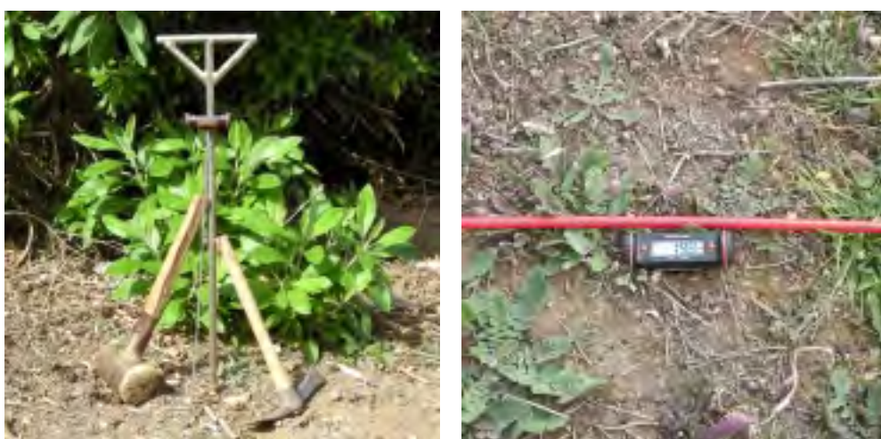
Figura 2 Termómetro T-Bar Digital Multi-Stem junto a herramientas de trabajo y detalle del termómetro
