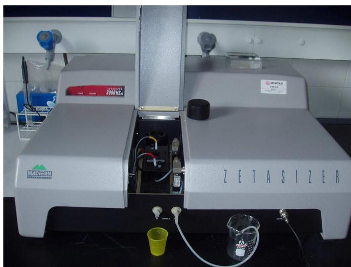
**Figura 4.3** Equipo para la medición del Potencial Zeta
