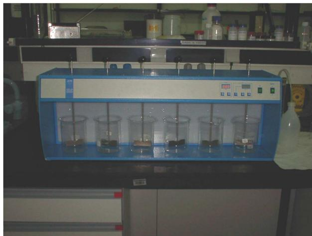
Figura 4.4 Aparato Jar Test
