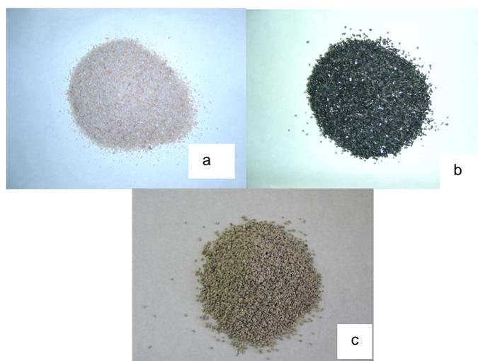
**Figura 4.7** Materiales empleados como medio filtrante: a) arena, b) antracita, c) pumita
