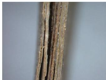
*Figura 7.26. Fotografía realizada con el microscopio digital Dino-Lite de la sección transversal de una muestra fabricada con hojas de platanera tras el ensayo de tracción (Fuente: propia).*
