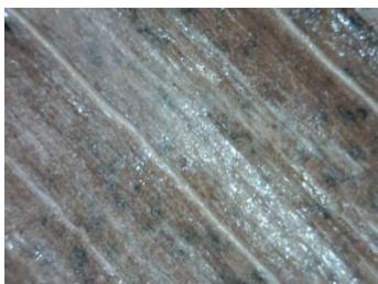
Figura 7.16. Fotografía realizada con el microscopio digital Dino-Lite de la superficie inferior de una muestra fabricada con hojas de platanera antes de ser ensayada (Fuente: propia).
