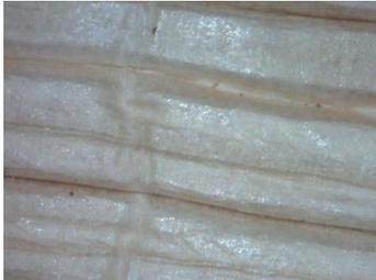
*Figura 7.36. Fotografía realizada con el microscopio digital Dino-Lite de la superficie superior de una muestra de platos comerciales de hojas de palma tras el ensayo de flexión (Fuente: propia).*
