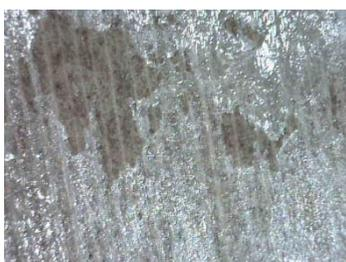
*Figura 7.34. Fotografía realizada con el microscopio digital Dino-Lite de la superficie inferior de una muestra fabricada con hojas de platanera tras el ensayo de flexión (Fuente: propia).*
