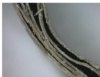
*Figura 7.35. Fotografía realizada con el microscopio digital Dino-Lite de la sección transversal de una muestra fabricada con hojas de platanera tras el ensayo de flexión (Fuente: propia).*
