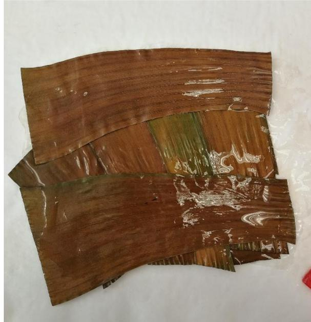
*Figura 8.2. Disposición de las distintas capas de hojas de platanera para la preparación del material compuesto y la fabricación de los platos (Fuente: propia).*
