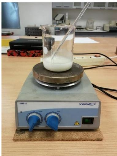
Figura 6.6. Preparación de adhesivo a base de almidón de patata soluble utilizando un agitador magnético con calefacción, VMS-A. (Fuente: propia).
