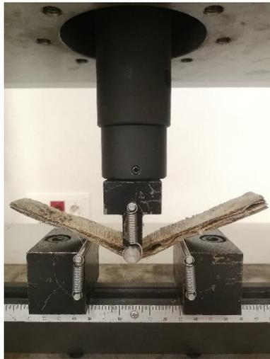
Figura 6.13. Ensayo de flexión realizado a una muestra conformada por badana de platanera (Fuente: propia).
