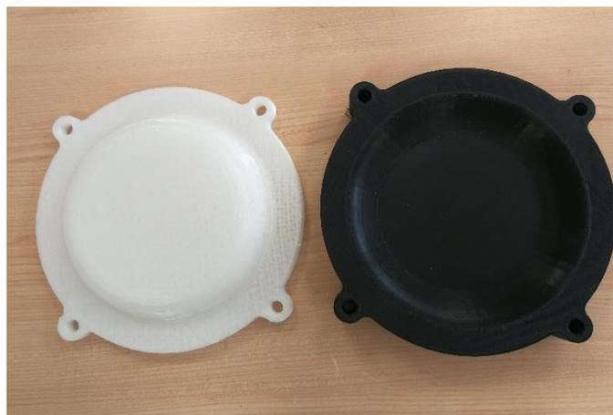
*Figura 8.1. Molde (tapa y base) para conformado de platos fabricado con impresora 3D (Fuente: propia).*
