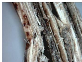
*Figura 7.32. Fotografía realizada con el microscopio digital Dino-Lite de la sección transversal de una muestra fabricada con badana de platanera tras el ensayo de flexión (Fuente: propia).*
