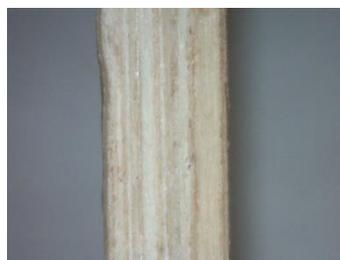
*Figura 7.29. Fotografía realizada con el microscopio digital Dino-Lite de la sección transversal de una muestra de platos comerciales de hojas de palma tras el ensayo de tracción (Fuente: propia).*
