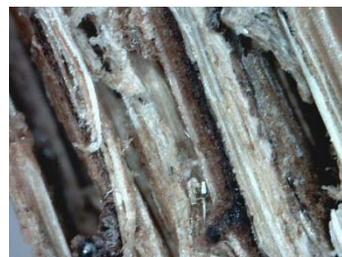
*Figura 7.23. Fotografía realizada con el microscopio digital Dino-Lite de la sección transversal de una muestra fabricada con badana de platanera antes de ser ensayada (Fuente: propia).*
