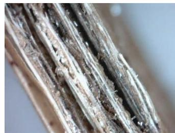
Figura 7.14. Fotografía realizada con el microscopio digital Dino-Lite de la sección transversal de una muestra fabricada con badana de platanera antes de ser ensayada (Fuente: propia).
