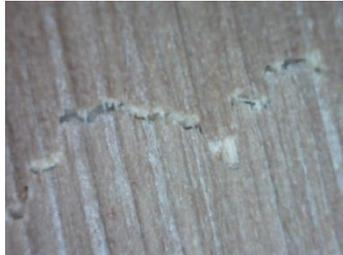
*Figura 7.37. Fotografía realizada con el microscopio digital Dino-Lite de la superficie inferior de una muestra de platos comerciales de hojas de palma tras el ensayo de flexión (Fuente: propia).*
