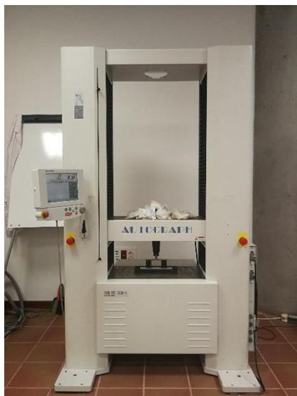
Figura 6.12. Máquina Universal Shimadzu Autograph AG-IS 50kN del Laboratorio de Materiales de la Escuela Superior de Ingeniería y Tecnología de la Universidad de La Laguna (Fuente: propia).
