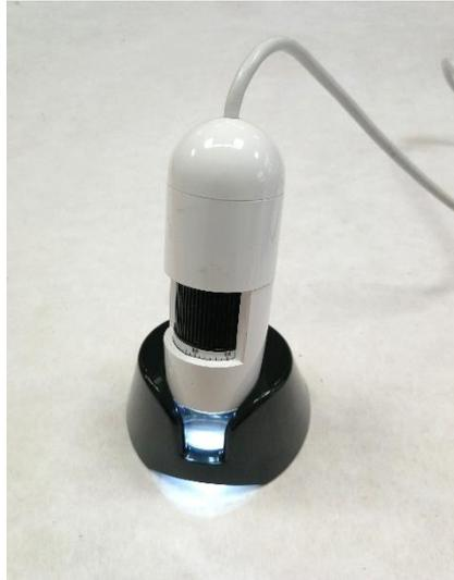
*Figura 6.21. Microscopio digital Dino-Lite AM- 211 (Fuente: propia).*
