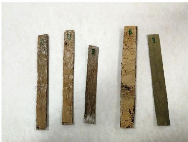
Figura 6.11. Muestras de materiales fabricados con hojas y badana de platanera y adhesivo a base de almidón de patata soluble (Fuente: propia).
