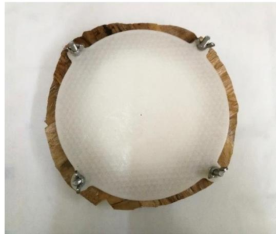
*Figura 8.4. Molde cerrado en el proceso de conformado de plato con badana de platanera (Fuente: propia).*
