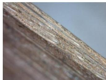
Figura 7.17. Fotografía realizada con el microscopio digital Dino-Lite de la sección transversal de una muestra fabricada con hojas de platanera antes de ser ensayada (Fuente: propia).
