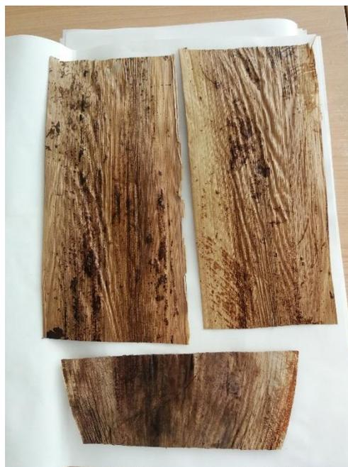
*Figura 6.4. Muestras de badana de platanera antes del proceso de secado (Fuente: propia).*
