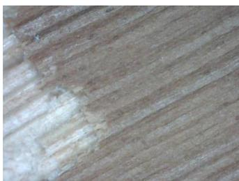
*Figura 7.28. Fotografía realizada con el microscopio digital Dino-Lite de la superficie inferior de una muestra de platos comerciales de hojas de palma tras el ensayo de tracción (Fuente: propia).*
