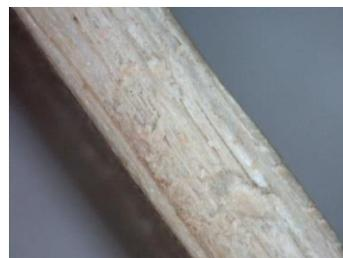
*Figura 7.20. Fotografía realizada con el microscopio digital Dino-Lite de la sección transversal de una muestra de platos comerciales de hojas de palma antes de ser ensayada (Fuente: propia).*
