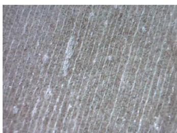
*Figura 7.33. Fotografía realizada con el microscopio digital Dino-Lite de la superficie superior de una muestra fabricada con hojas de platanera tras el ensayo de flexión (Fuente: propia).*
