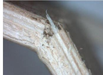
*Figura 7.38. Fotografía realizada con el microscopio digital Dino-Lite de la sección transversal de una muestra de platos comerciales de hojas de palma tras el ensayo de flexión (Fuente: propia).*
