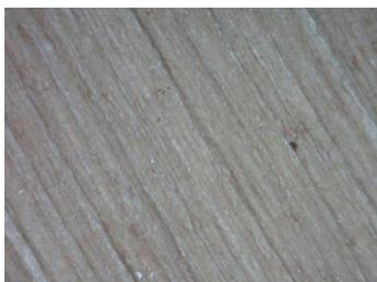
*Figura 7.18. Fotografía realizada con el microscopio digital Dino-Lite de la superficie superior de una muestra de platos comerciales de hojas de palma antes de ser ensayada (Fuente: propia).*
