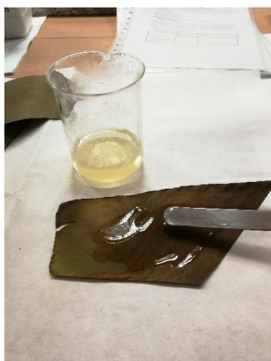
Figura 6.8. Preparación de muestras con hojas de platanera y adhesivo a base de almidón de patata soluble (Fuente: propia).
