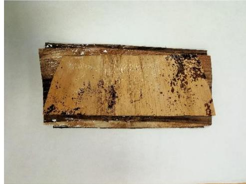
*Figura 6.10. Muestras de badana de platanera y adhesivo a base de almidón antes de la fase de secado (Fuente: propia).*
