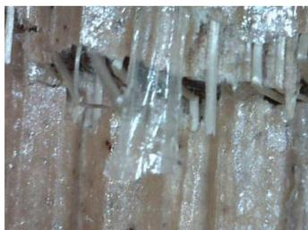
*Figura 7.22. Fotografía realizada con el microscopio digital Dino-Lite de la superficie inferior de una muestra fabricada con badana de platanera tras el ensayo de tracción (Fuente: propia).*
