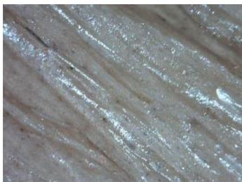
Figura 7.12. Fotografía realizada con el microscopio digital Dino-Lite de la superficie superior de una muestra fabricada con badana de platanera antes de ser ensayada (Fuente: propia).
