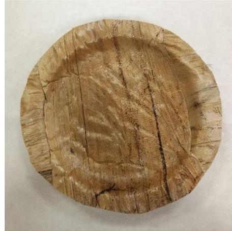
Figura 8.6. Modelo de plato conformado con badana de platanera (Fuente: propia).
