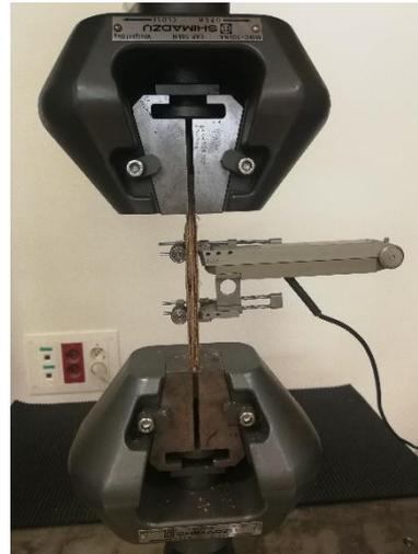
Figura 6.14. Ensayo de tracción realizado a una muestra conformada por badana de platanera (Fuente: propia).
