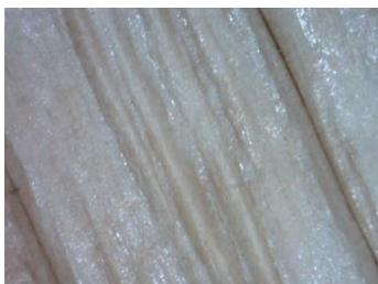
*Figura 7.19. Fotografía realizada con el microscopio digital Dino-Lite de la superficie inferior de una muestra de platos comerciales de hojas de palma antes de ser ensayada (Fuente: propia).*
