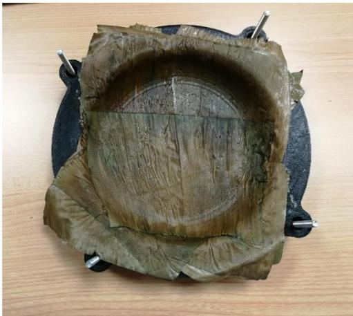
*Figura 8.3. Proceso de conformado de plato con hojas de platanera (Fuente: propia).*
