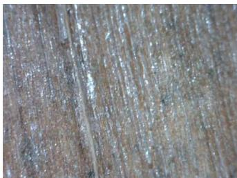
*Figura 7.25. Fotografía realizada con el microscopio digital Dino-Lite de la superficie inferior de una muestra fabricada con hojas de platanera tras el ensayo de tracción (Fuente: propia).*
