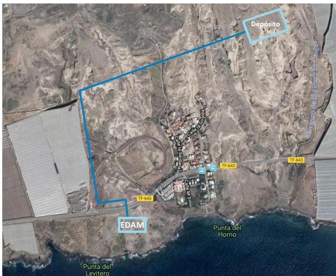
Figura 12: Recorrido de la tubería de distribución hasta el depósito de regulación (Fuente: Elaboración propia. Goolzoom)
