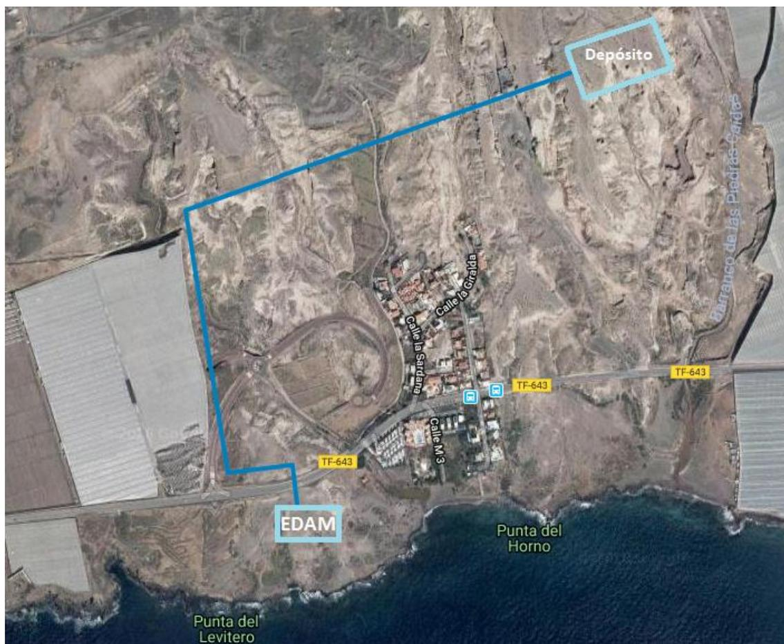
Figura 54: Recorrido de la tubería de distribución hasta el depósito de regulación (Fuente: Elaboración propia. Goolzoom)
