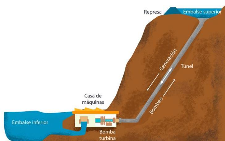
Figura 15: Bombeo hidráulico (Fuente: Energía (2013) Origo Ed. Chile)
