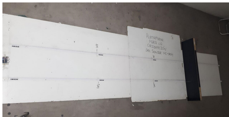
(c) Plataforma con cintas métricas y tabla utilizada como objeto contra el que rebotar
