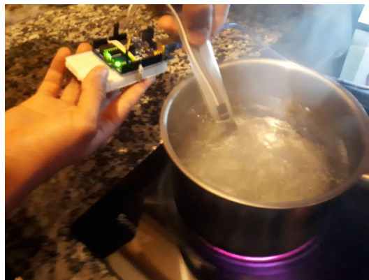
(b) Introducción del sensor en el entorno de ebullición
