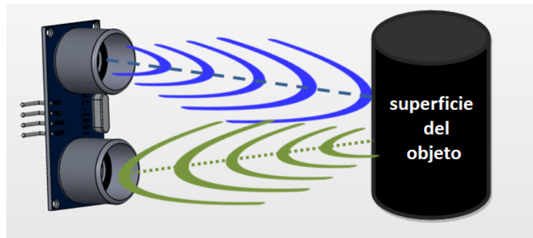
Figura 6.3: Principio de funcionamiento del Sensor de Ultrasonidos HC-SR04
