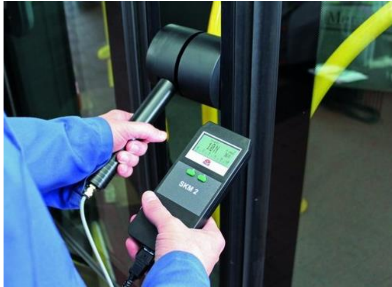
Fig. 18. Medidor de fuerza de cierre de puertas de servicio servoaccionada y otros dispositivos de bloqueo.
