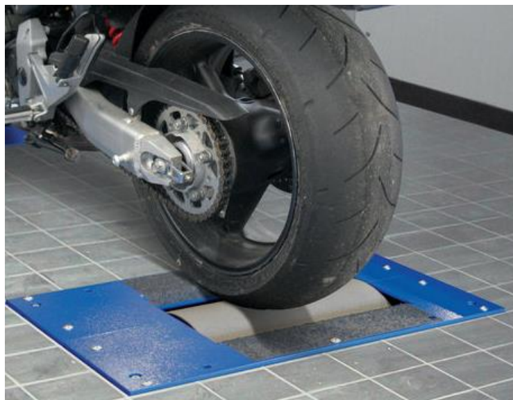
Fig. 21. Velocímetro para la evaluación de la desviación de la velocidad del tacómetro en vehículos a dos ruedas.
