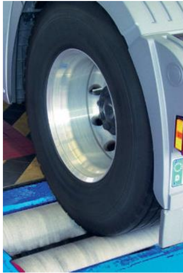
Fig. 11. Simulador que permite valoración de la desviación de la velocidad del tacómetro en turismos y camiones.
