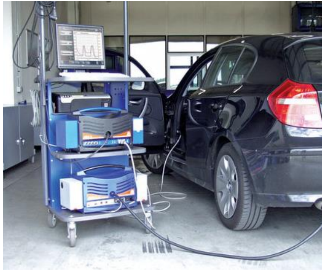
Fig. 9. Analizador de gases de corriente parcial sin indicador (unidad básica) para el análisis de HC, CO, CO 2 , O 2 con diagnóstico de la opacidad de los gases.
