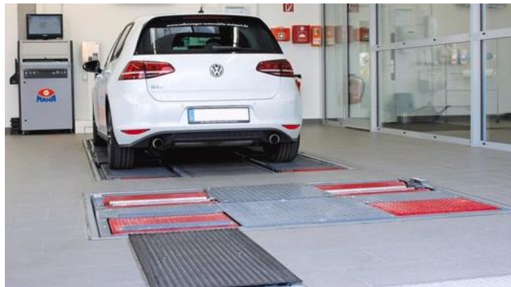
Fig. 4. Frenómetro de rodillos apto para líneas de ensayo para turismos y furgonetas hasta una carga axial de 3500 kg.
