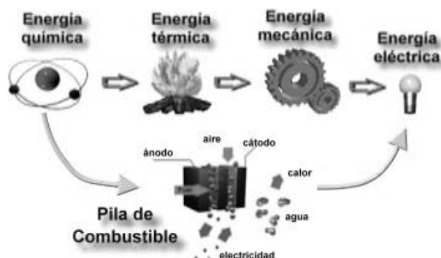
Fig. 1.1. Esquema mostrando la transformación de energía química en eléctrica, por medio de los generadores tradicionales y por medio de una pila de combustible.
