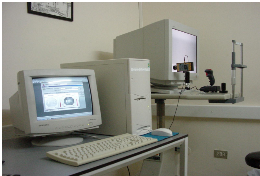
FIGURA 19: Perimetría PULSAR: (1) Unidad de Control; (2) Pantalla de alta resolución; (3) Fotómetro
