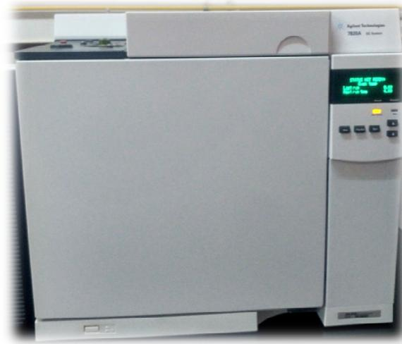
**Figura 3.2. Cromatógrafo de gases, Agilent 7820**
