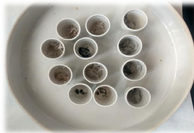
**Figura 3.11. Muestras para medir los sólidos en suspensión.**
