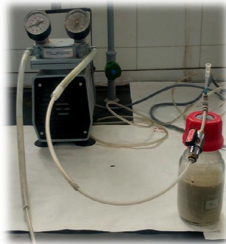
**Figura 3.6. Realización de vacío para una muestra.**
