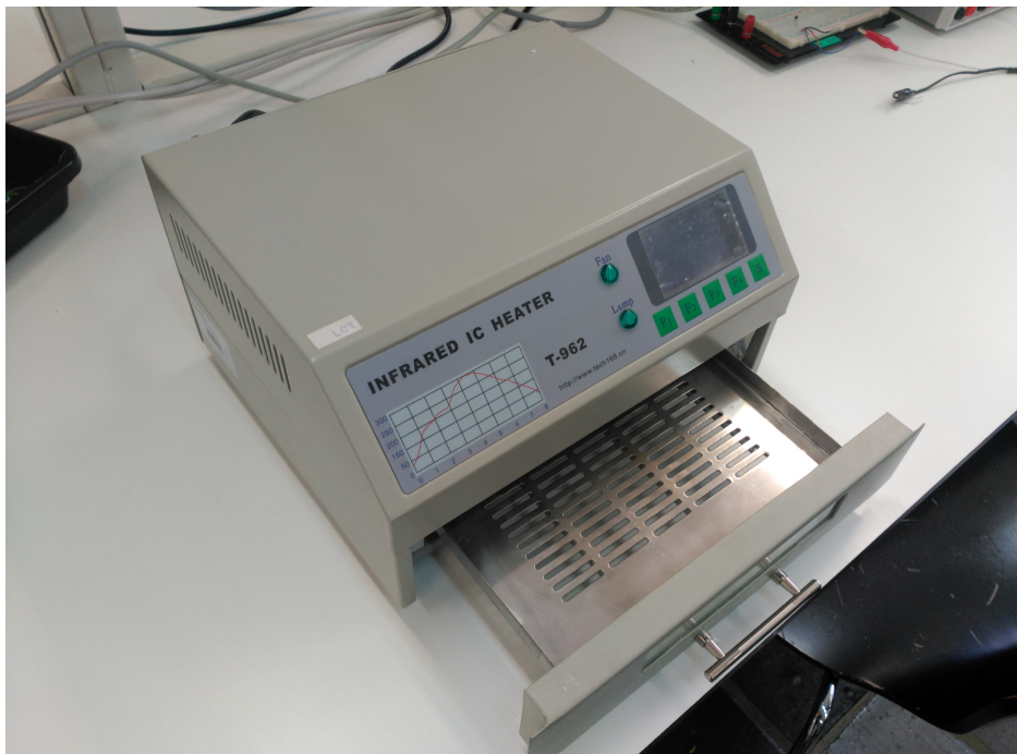
Figura 4.4: Horno para las placas de circuitos impresos.
