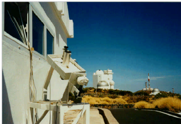
Figura 4.2.4. Fotografía del seguidor solar con el tubo colimador y el tubo de seguimiento.
