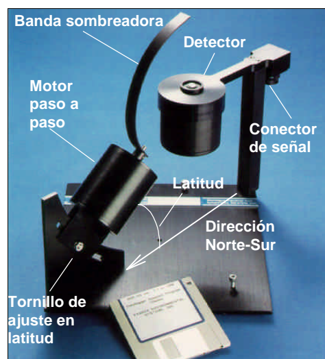
Figura 4.1.1. Radiómetro multifiltro con sombreador de banda giratoria (MFRSR).
