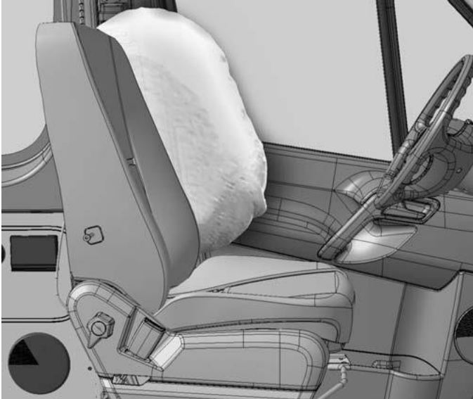
Zona de despliegue del Thoraxbag, veh culo, lado izquierdo
